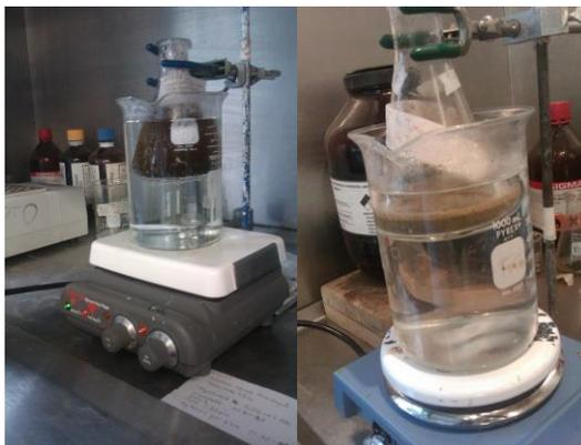
**Figura E6. Fracción orgánica y fracción reducible.**
