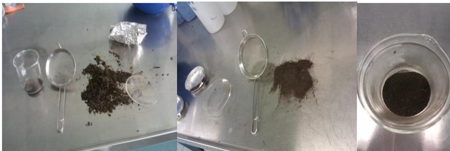
**Figura E2. Trituración y tamizado de la composta**
