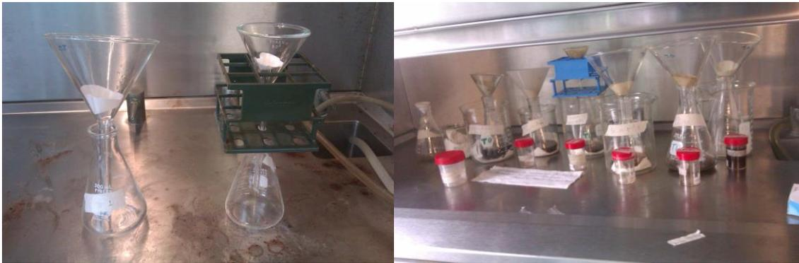
**Figura E4. Filtración de muestras.**
