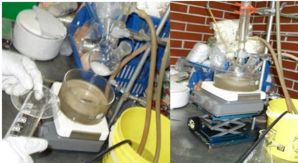
Figura A1. Preparación del estearato de sodio
