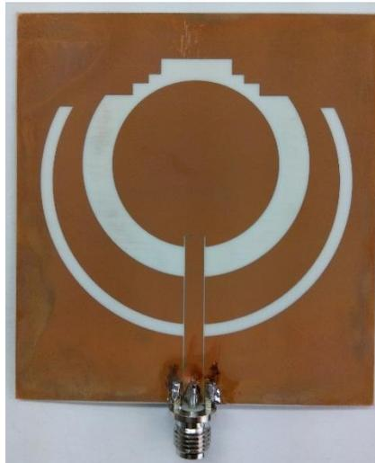
Figura 4.7 Antena con conector soldado
