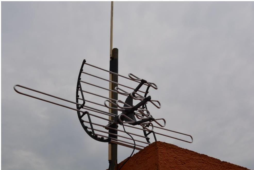
**Figura 5-18 Antena directiva para televisión digital**
