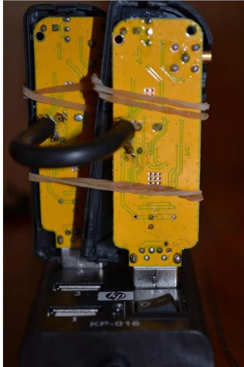
Figura 4-12. Cable coaxial utilizado para sincronizar ambos RTLSDR.
