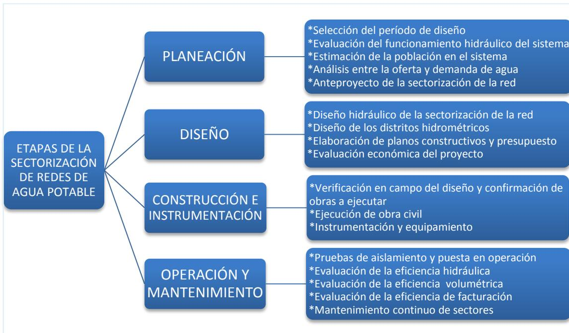
Figura 3.4. Etapas de la sectorización de redes de agua potable. Adaptado de Ochoa (2014)
