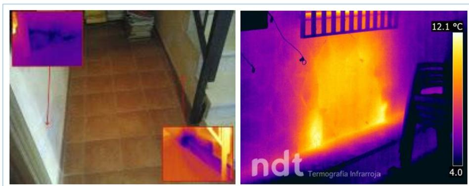
Figura 2.16. Localización de fugas por termografía infrarroja. Fuente: NDT Termografía infrarroja (2011)
