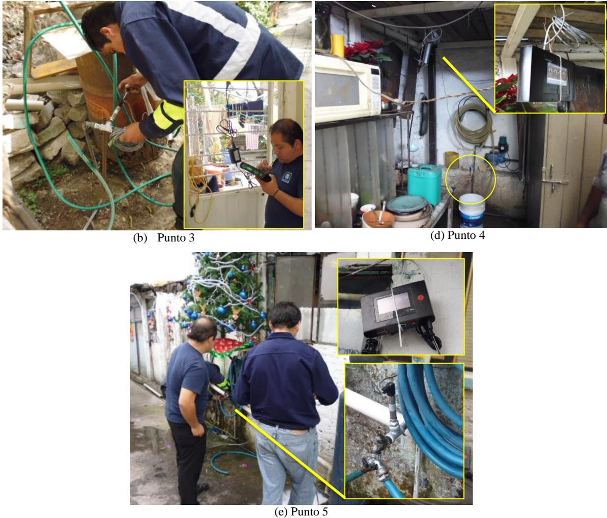
Figura 6. 22. Medición de presión con Data logger en tomas domiciliarias del sector SH-5
