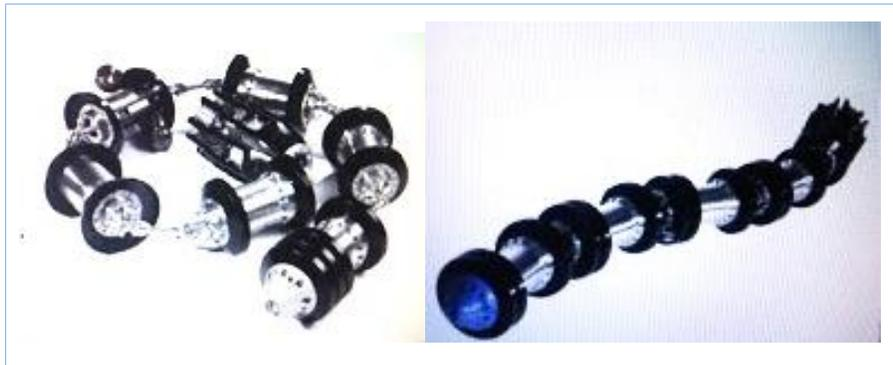
Figura 2.13. Oruga de inspección. Fuente: <http://fugatec.com/blog/tecnologia-para-la-deteccion-y-localizacion-de-fugas-de-agua/>
