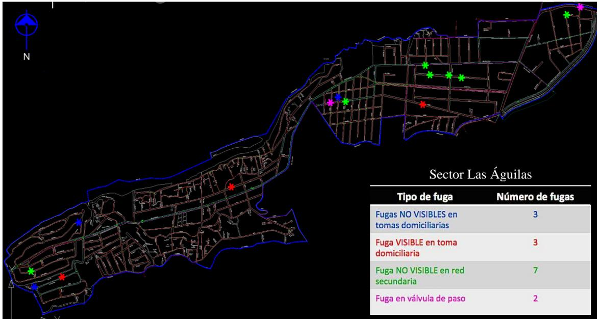
Figura 6.7. Fugas detectadas en el Sector Las Águilas. Fuente: SACMEX (2013)
