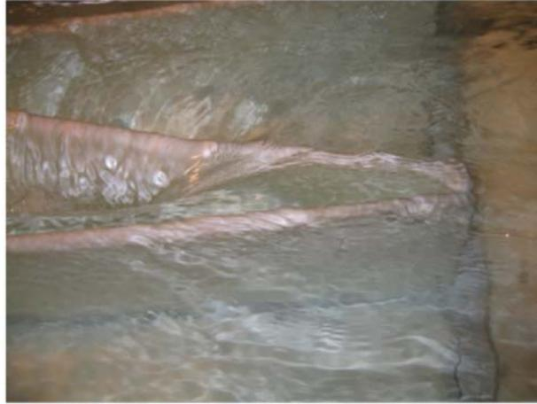
Fig 23. Interferencia de la lámina vertiente. Crookston 2010.
