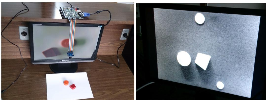
Figura 4.5 Ejemplo del funcionamiento de la adquisición de imágenes y del protocolo de comunicación VGA. A la izquierda se muestra una imagen sin procesamiento alguno; y a la derecha se despliega otra imagen en escala de grises.
