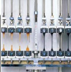
Figura 46. Fatiga por flexión en cauchos de silicón Shin-Etsu [28].
