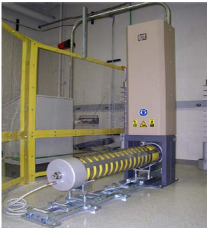
Figura 4.18. Máquina S4 – Banco de pruebas de laboratorio de Chevron Philips Chemical Compani, LLC (Palermo, 2010).
