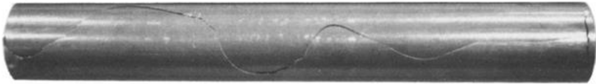
Figura 4.2. Propagación rápida de falla en un tubo de PVC con aire atrapado (Greenshields & Leever, 1996)
