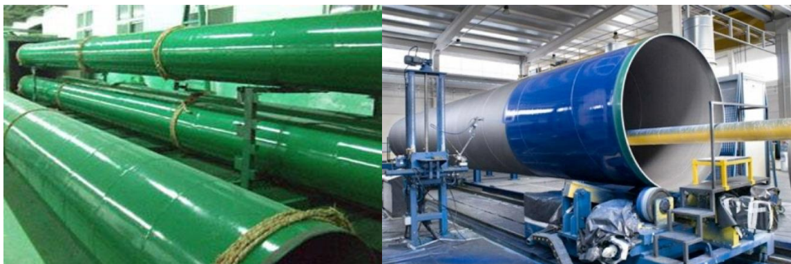
Figura 1.12. Tuberías de acero con revestimiento externo de polietileno.
