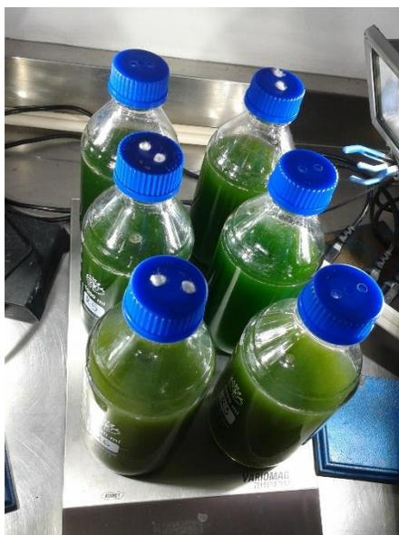
Figura 26 Reactores después de 2 ciclos de operación. (reactores de 900 mL, agitación magnética: 150 – 200 rpm)
