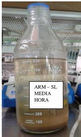
Figura 49 Sedimentación reactor ARM-SL
