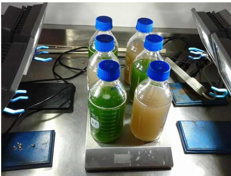
Figura 7 Montaje experimental diferentes sustratos: pertinencia de la inoculación con microalgas.
