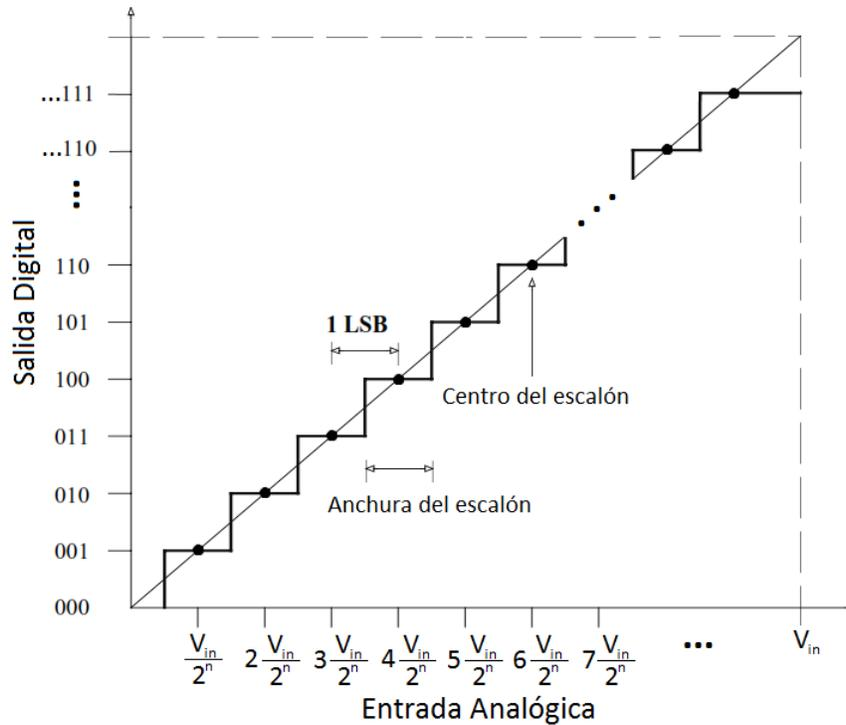
Figura 12: Relación entrada-salida en un convertidor analógico-digital ideal
