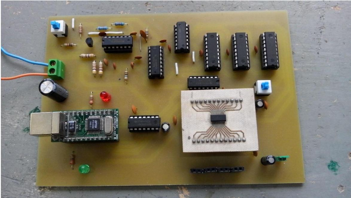
Figura 33: Circuito impreso de la tarjeta digitalizadora.
