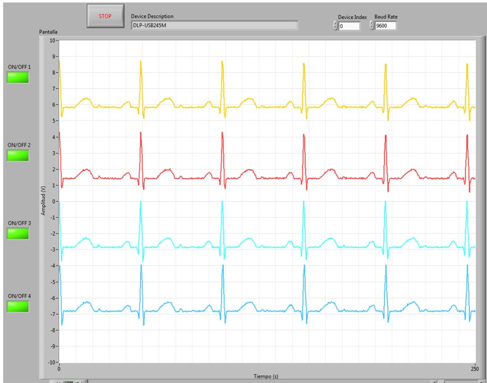
Figura 30: Visualización de una señal cardiaca de  $V_p = 2[V]$  y  $f_{in} = 100[Hz]$ .
