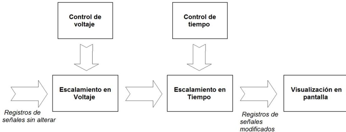
Figura 26: Diagrama de bloques para la creación de las señales de acuerdo con el usuario.
