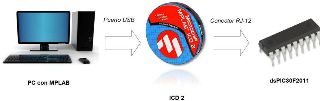
Figura 22: Estructura general para el uso del MPLAB ICD 2.
