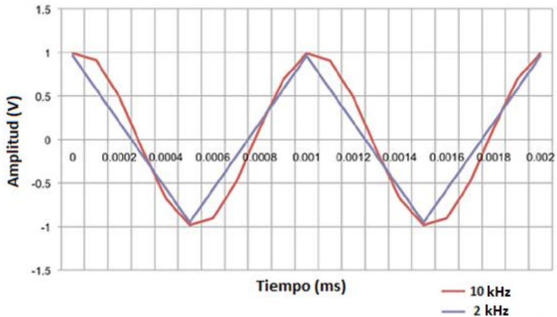
Figura 9: Reconstrucción de una señal senoidal de 1kHz con dos diferentes velocidades de muestreo.
