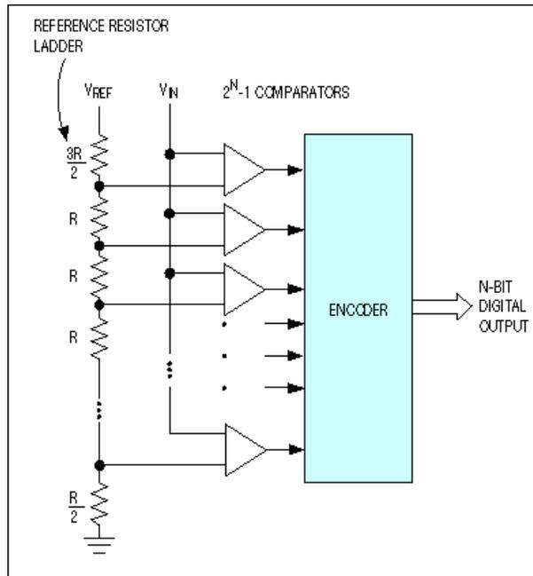
Figura 5: Estructura general de un convertidor analógico-digital tipo flash.
