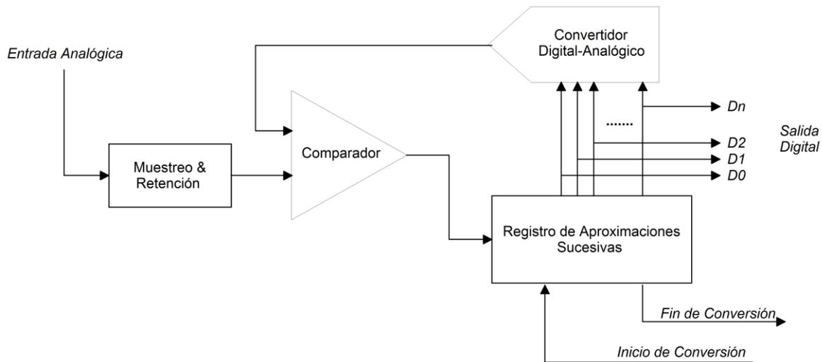
Figura 7: Estructura general de un convertidor analógico-digital por aproximaciones sucesivas.
