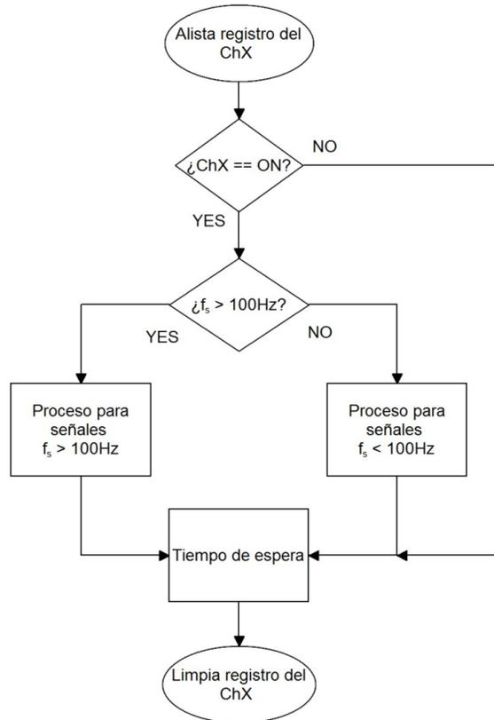
Figura 25: Diagrama de flujo para el proceso de las señales de acuerdo con la velocidad de muestreo.
