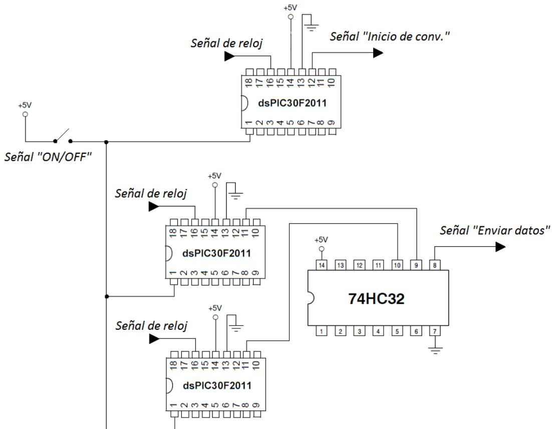
Figura 20: Diagrama de conexiones del conjunto de dsPIC30F2011.
