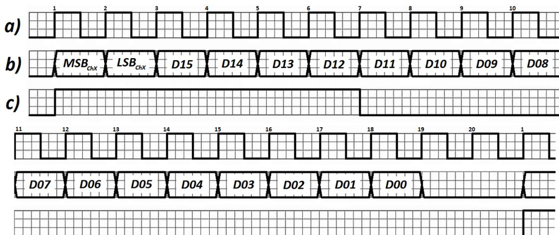
Figura 13: Diagrama de tiempo con a) la señal de reloj, b) la salida serial de los datos y c) la señal de inicio de conversión.
