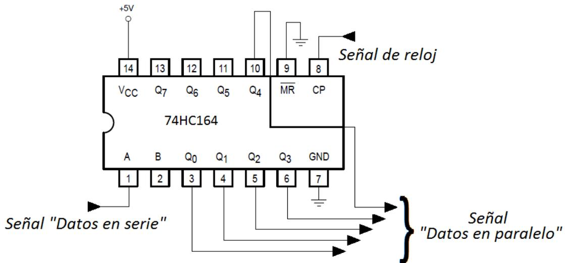
Figura 16: Diagrama de conexiones del registro de corrimiento.
