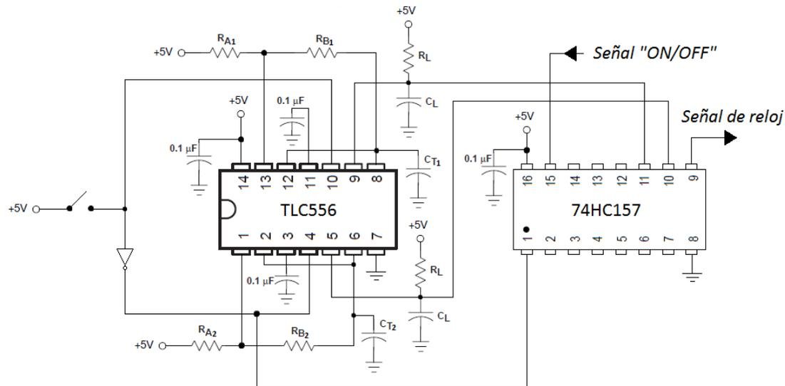
Figura 15: Diagrama de conexiones de la señal de reloj.
