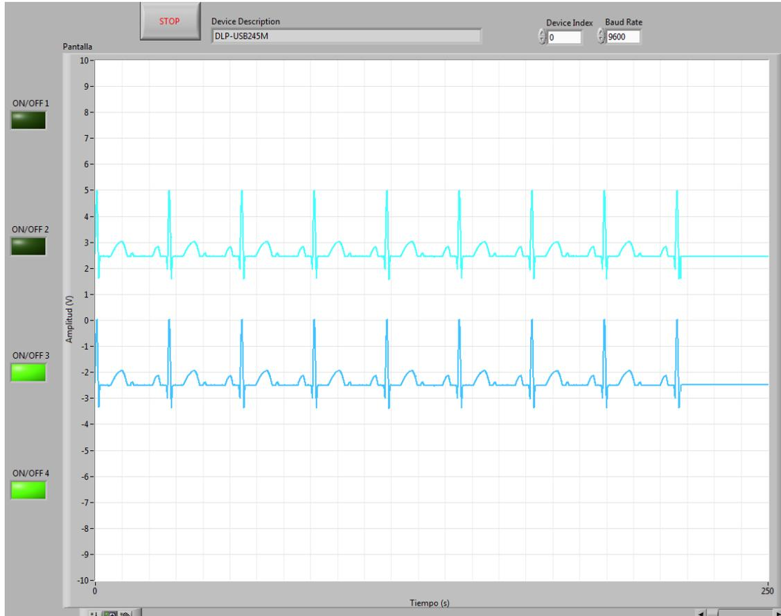
Figura 32: Visualización de una señal cardiaca de  $V_p = 2[V]$  y  $f_{in} = 2[Hz]$ .
