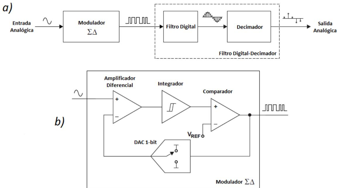
Figura 6: a) Estructura general de un convertidor analógico-digital tipo sigma-delta y b) bloques internos del modulador  $\Sigma\Delta$ .
