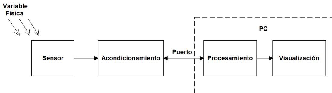
Figura 4: Estructura básica de un sistema de adquisición de datos.
