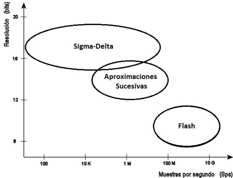
Figura 8: Gráfica de comparación entre los tipos de convertidores.
