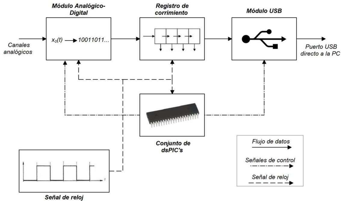
Figura 29: Estructura por bloques de la tarjeta digitalizadora.
