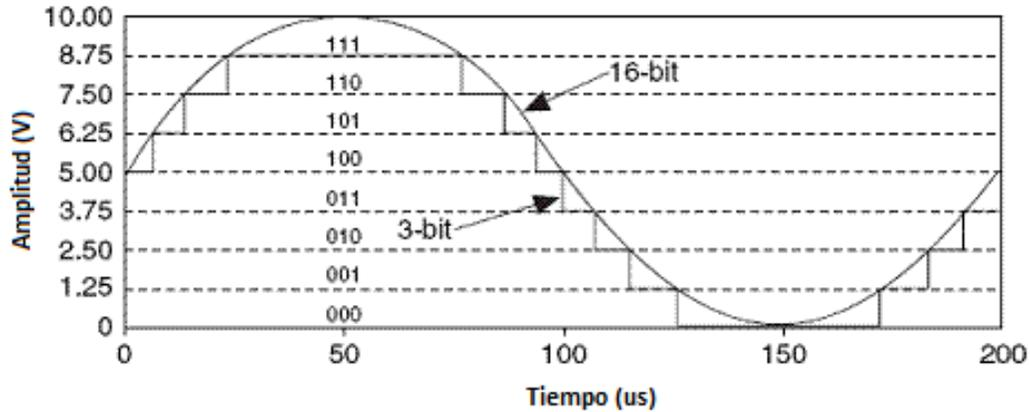
Figura 11: Representación de una señal senoidal con dos resoluciones diferentes, a 3 bits y a 16 bits.
