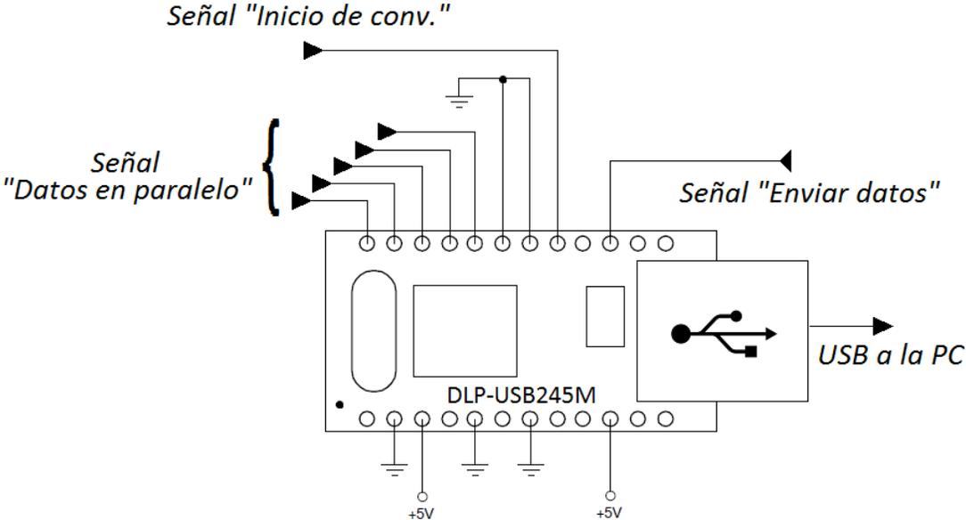
Figura 17: Diagrama de conexiones del módulo USB.
