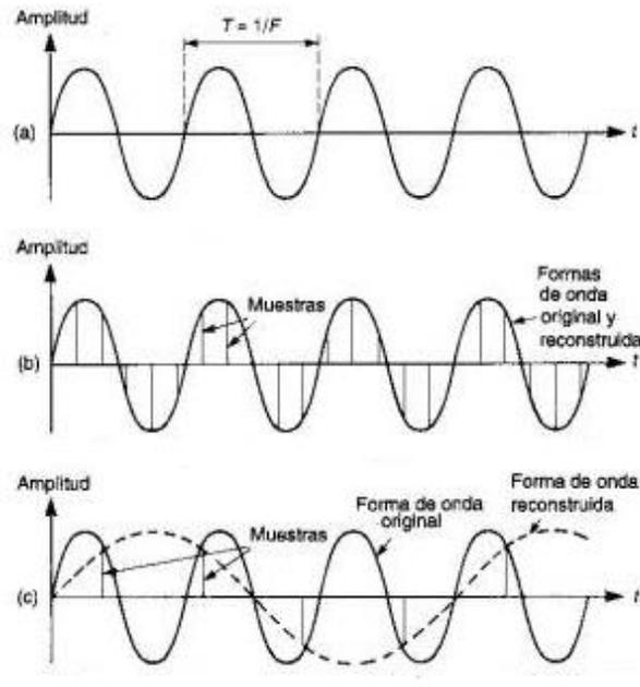
Figura 10: a) una señal senoidal muestreada con b) una frecuencia mayor a la de Nyquist y a c) una frecuencia menor a la de Nyquist (aliasing).
