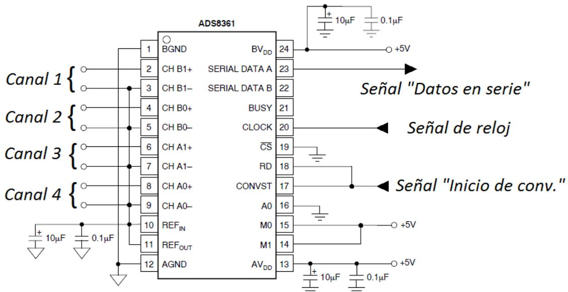
Figura 14: Diagrama de conexiones del convertidor ADS8361.
