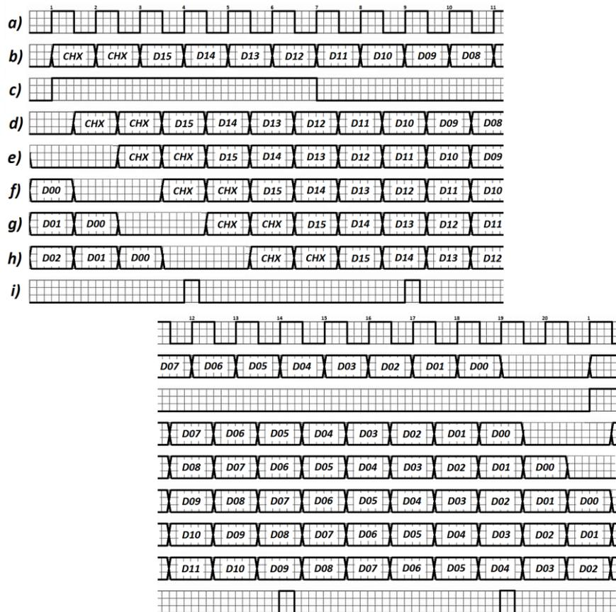
Figura 18: Diagrama de tiempos de las señales de la tarjeta al momento de una conversión, donde a) señal de reloj, b) salida serial del convertidor, c) señal de inicio de conversión, d) e) f) g) h) salida paralela del registro de corrimiento e i) señal indicadora de envío de datos.
