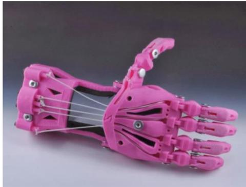
**Figura 1.13.** Prótesis basada en tendones hecha por impresión 3D.
