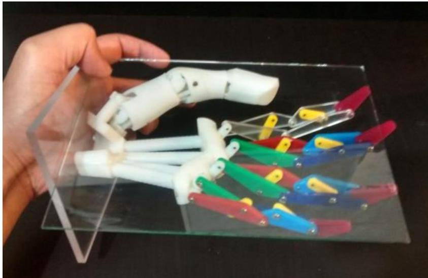
**Figura 5.15.** Empuje de plataforma. Nótese que el pulgar puede posicionarse por debajo y encima del plano del cristal, esto se debe a sus movimientos de flexión/extensión y abducción/aducción en las juntas CMC y MCP.
