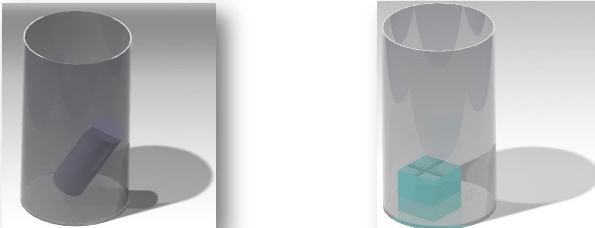
Figura 4.6. Representación de hielo cúbico y cilíndrico de 15.1 gr en un vaso pequeño de 63 mm de diámetro y una altura de 112 mm
