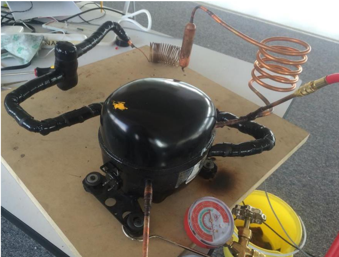
Figura 5.11. Sistema de refrigeración aislado y con el manómetro conectado.
