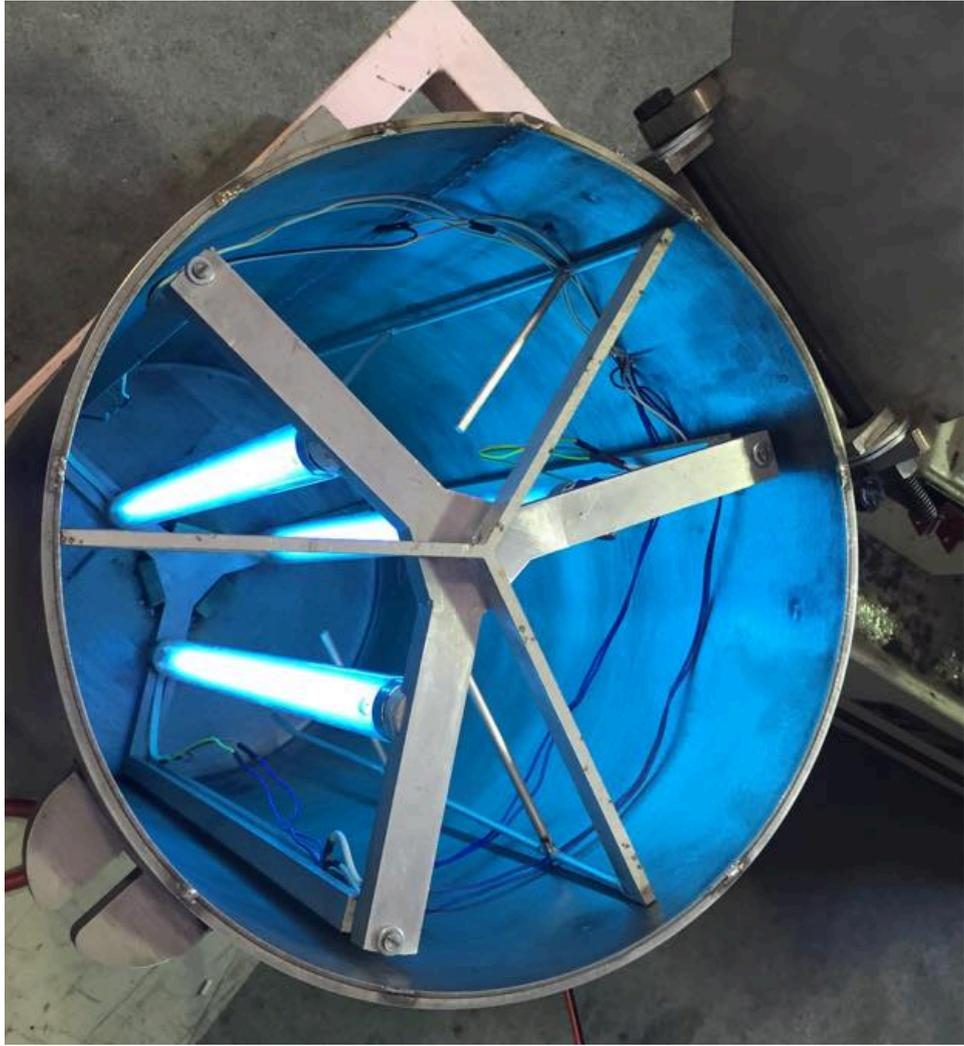
*Figura 14 Imagen del equipo encendido mostrando el cableado antes de instalar las canaletas.*
