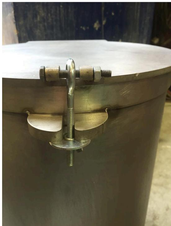
*Figura 18 Imagen del sistema de cierre con cinturón de refuerzo.*
