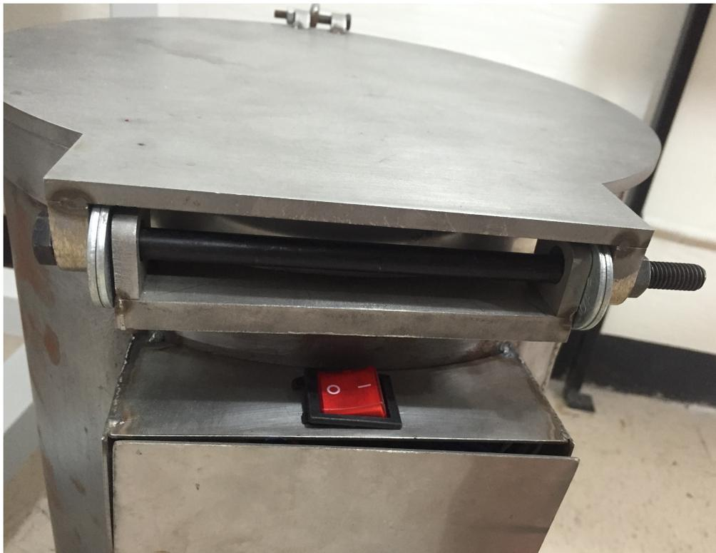
*Figura 9 Imagen de cámara y tapa y sistema de cierre.*
