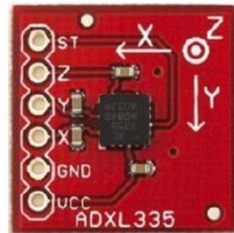
**Figura 3.2 Patillaje del acelerómetro ADXL335 de sparkfun [6]**
