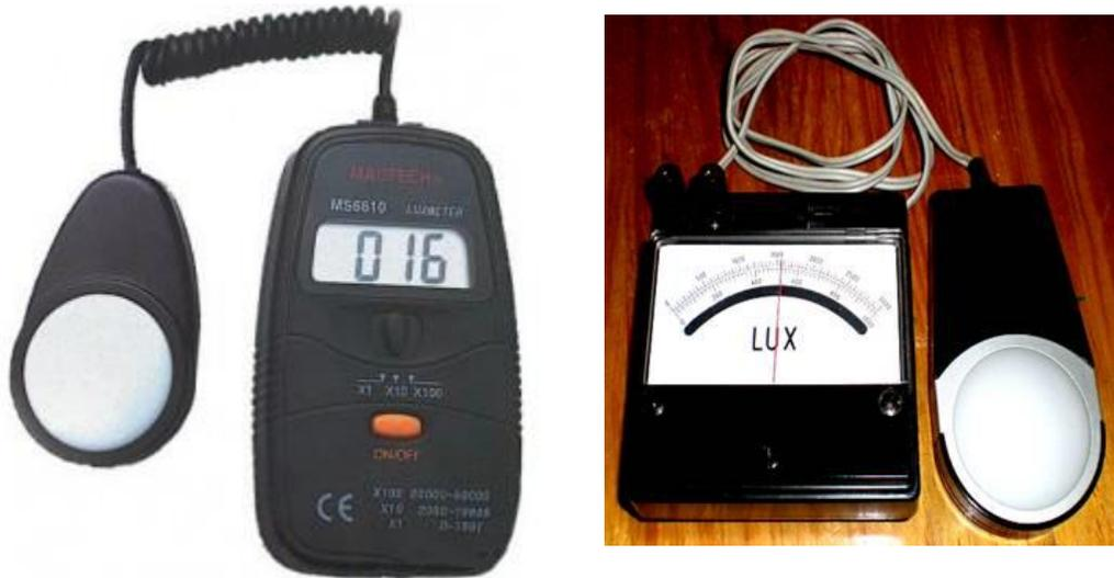
**Figura 2.6. Luxómetros digital[14] y analógico[18] .**
