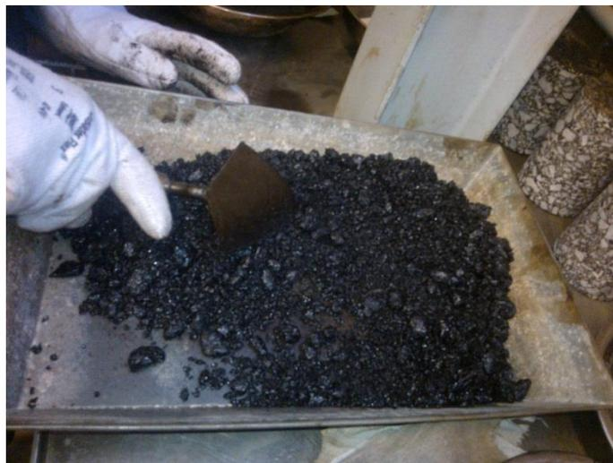
Figura 3.7. Mezcla asfáltica suelta para densidad de Rice
