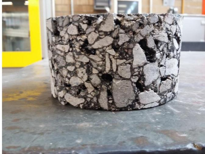
*Figura 2.5. Mezcla asfáltica compactada abierta elaborada en laboratorio*
