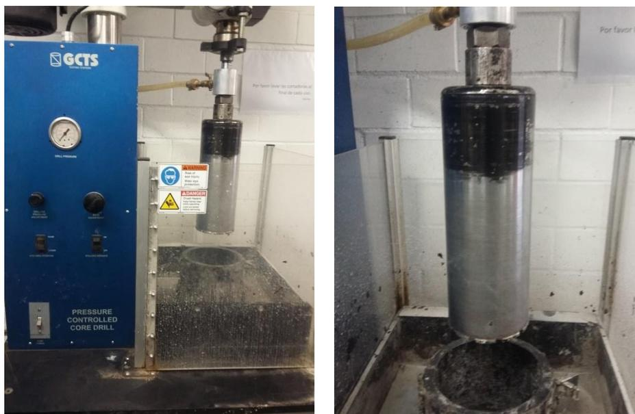
Figura 3.13. Extractor de núcleos de concreto asfáltico
