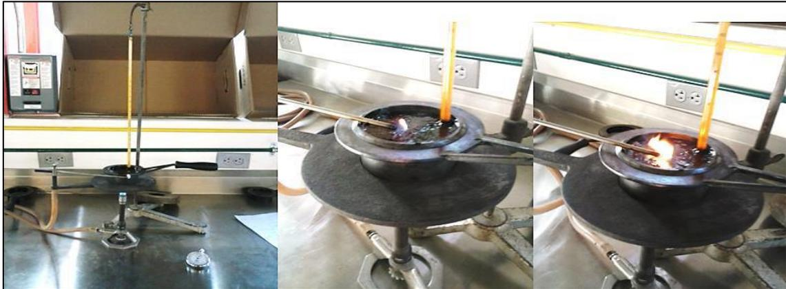
Figura 2.22. Ensayo de punto de inflamación (Martínez, O., 2014)
