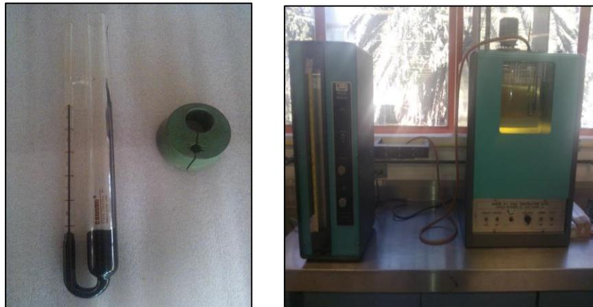
Figura 2.18. Ensayo de viscosidad dinámica (Josephia, R., 2015)
