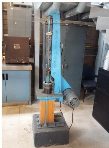
*Figura 2.29. Compactador Marshall*
