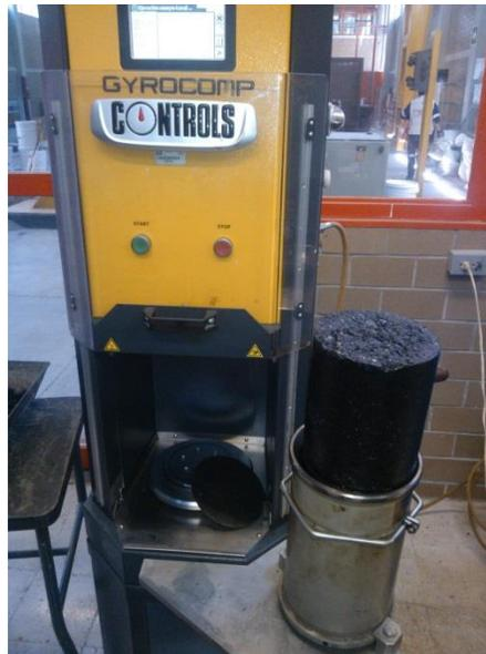
Figura 3.12. Extracción de la mezcla compactada
