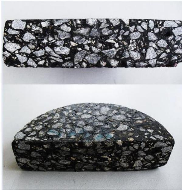
Figura 2.6. Mezcla asfáltica tipo SMA (Martínez, O., 2014)
