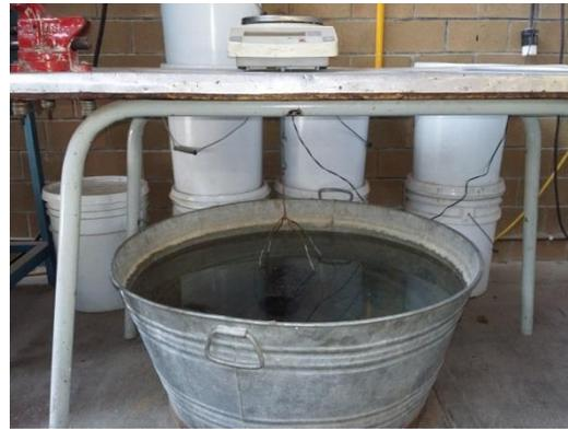
*Figura 3.15. Determinación de la densidad bruta G<sub>mb</sub>*
