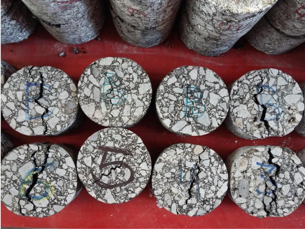
*Figura 4.4. Grietas de falla en especímenes ensayados*
