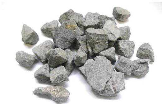
*Figura 2.10. Agregado grueso con caras fracturadas (Martínez, O., 2014)*
