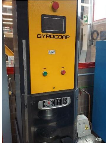
Figura 2.30. Compactador giratorio Superpave
