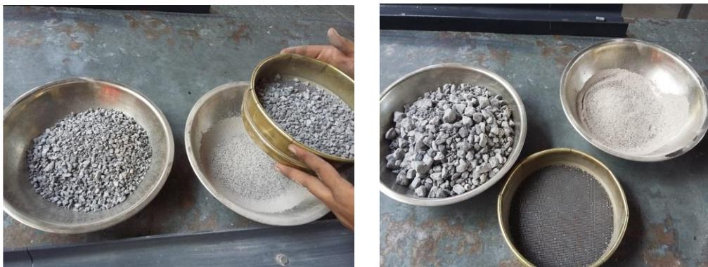
*Figura 2.14. Material pétreo cribado después del desgaste*
