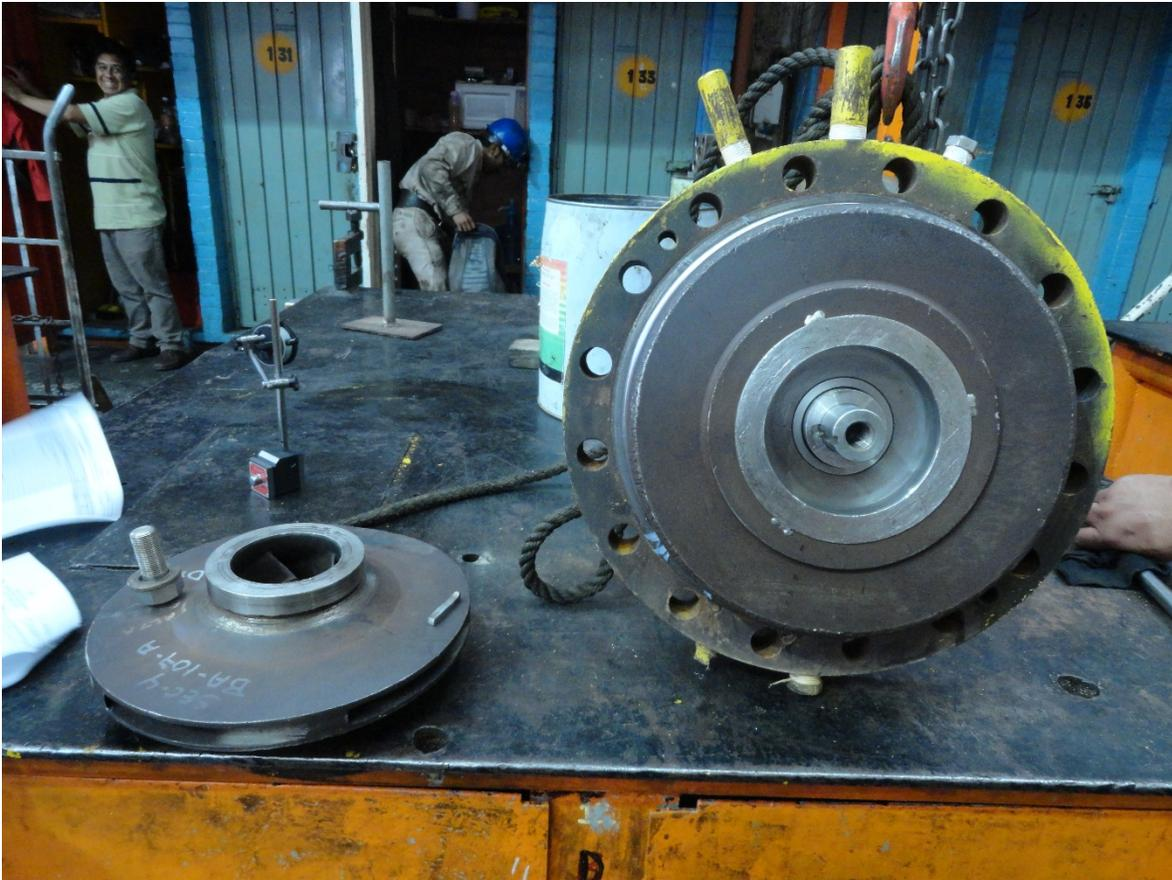
5.- DESMONTAJE DE IMPUSOR, REVISIÓN DE ANILLOS ASÍ COMO SU DIMENCIONAMIENTO.
