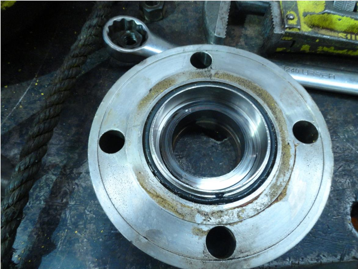
7.- REVISIÓN DE SELLO MECÁNICO ESTACIONARIO, SE OBSERVA QUE LA FUGA FUE A CAUSA DE RUTURA DE ANILLO ELASTOMERO.
