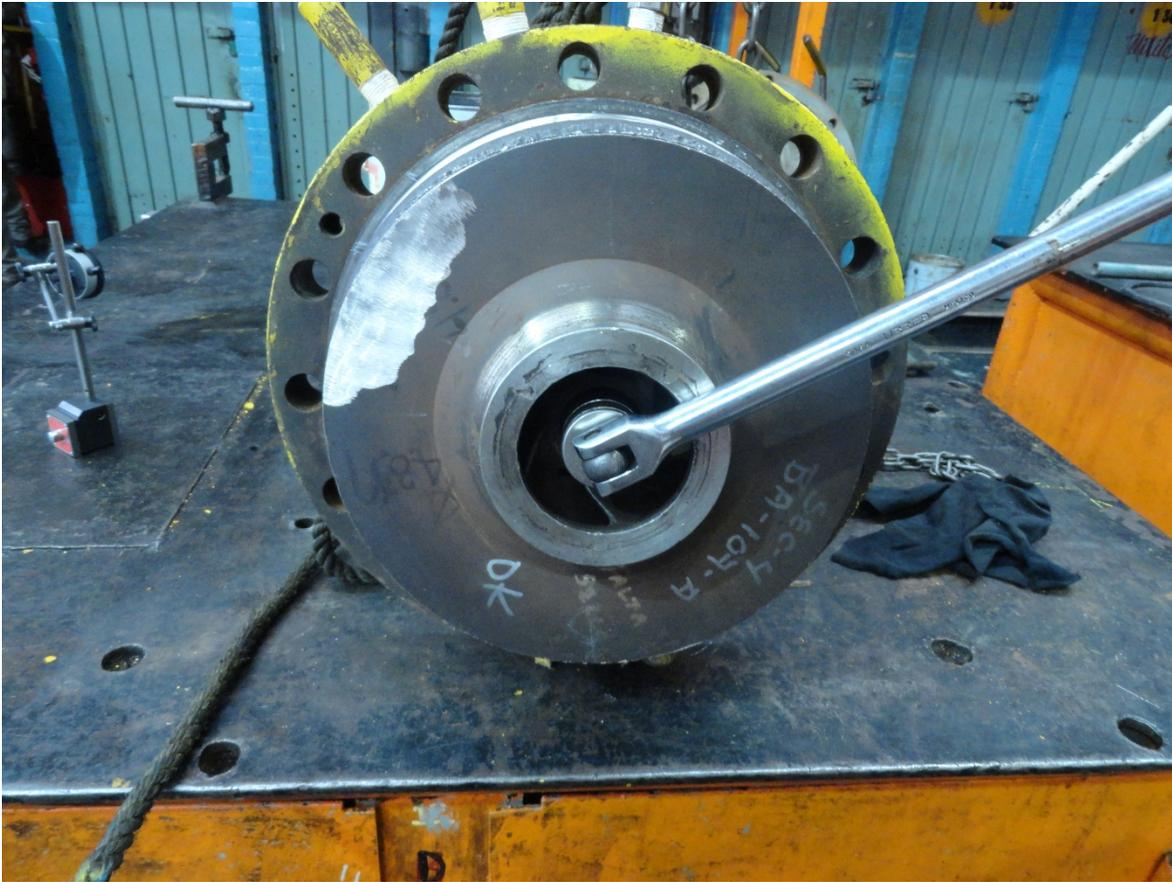
4.- RETIRAR TORNILLO SUJETADOR DE IMPULSOR.
