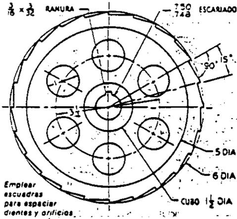
Fig. 2.93 Rueda dentada o de triquete. Empleando el plan A-2, dibuje a lápiz. Omite dimensiones y notas.
