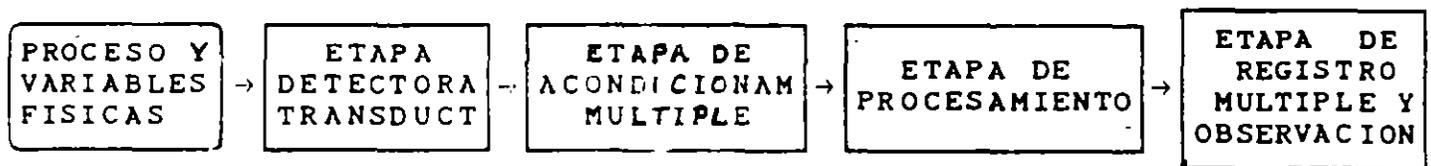
EN LA FIGURA 5 SE MUESTRA UN DIAGRAMA ESQUEMATICO DE ESTOS SISTEMAS DONDE SE OBSERVA QUE SE HA AGREGADO, UNA ETAPA DE PROCESAMIENTO POSTERIOR AL ACONDICIONAMIENTO MULTIPLE. ESTA NUEVA ETAPA ES LA MAS IMPORTANTE DEL SAPD, PORQUE ES LA RESPONSABLE DE OBTENER, A PARTIR DE TODA LA INFORMACION RECOGIDA, LOS ELEMENTOS DE JUICIO NECESARIOS Y RESUMIDOS PARA EVALUAR, CORREGIR, CONDUCIR O CONTROLAR EL PROCESO EN CUESTION.
