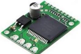
Driver     | <ul style="list-style-type: none"> <li>-Puente H integrado para manejo de un solo motor.</li> <li>-5.5 a 24V de alimentación para el motor.</li> <li>-Puede liberar corriente continua de 12A. (30A pico)</li> <li>-Trabaja con niveles lógicos de 2.5 a 5V.</li> <li>-Protección contra sobre-voltaje o voltaje en reversa, temperatura y corrientes elevadas.</li> </ul> |
