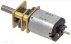
Micromotor | <ul style="list-style-type: none"> <li>-Dimensiones: 0.94" x 0.39" x 0.47"</li> <li>-Motor con escobillas 6V. 320RPM, 120 mA rotor libre, 1.6A rotor bloqueado, 2.2 Kgf-cm de par nominal.</li> <li>-Gearbox: 100.37:1</li> <li>-Eje en forma de "D" 3mm de diámetro. 9mm de largo.</li> </ul>                                                                             |
