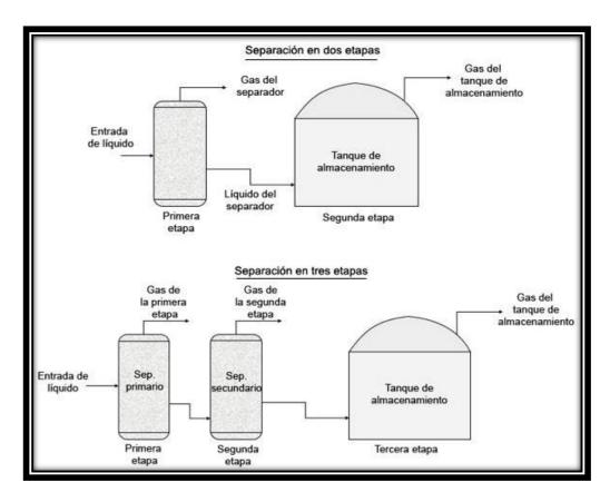
Figura 2-22 Batería de separación de dos (superior) y tres etapas (inferior).
