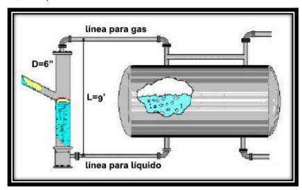
Figura 3-10 Configuración de un separador GLCC como pre – separador (Modificado de Gomez et al., 2000).
