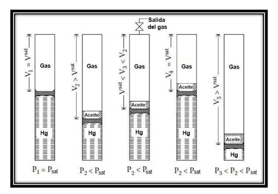
Figura 1-6 Representación del experimento PVT de agotamiento a volumen constante (Modificado de Pedersen et al., 2007).
