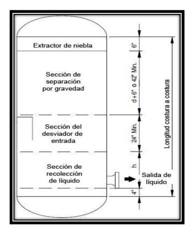
Figura 2-33 Longitud costura a costura de un separador vertical (Modificado de Arnold et al., 2008).
