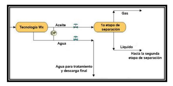
Figura 4-17 Separación previa mediante el uso de la tecnología Wx (Modificado de Wordsworth et al., 2011).
