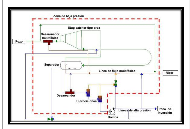
Figura 4-18 Esquema del Sistema de Separación Submarina de Agua y Aceite Marlim (Modificado de Greco et al., 2012).
