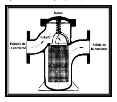
Figura 2-2 Esquema de un eliminador (Modificado de Szilas, 1986).
