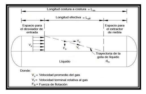
Figura 2-28 Separador horizontal lleno a 50% de su capacidad de líquido (Modificado de Arnold et al., 2008).
