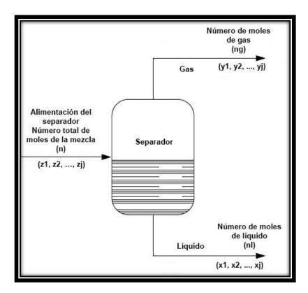
Figura 1-9 Principio de separación de una mezcla de hidrocarburos (Modificado de Pedersen et al., 2007).
