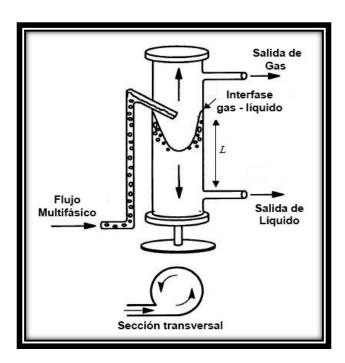
Figura 3-6 Configuración de un separador de gas – líquido ciclónico cilíndrico (Modificado de Gomez et al., 2000).
