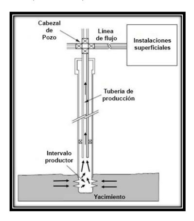
Figura 1-1 Trayecto de los fluidos del yacimiento hacia superficie (Modificado de Heriot - Watt, 2012).
