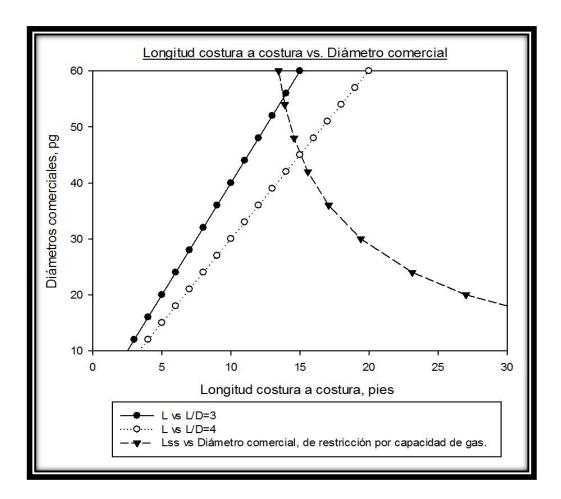
Las rectas, las cuales representan gráficamente el criterio de relación de esbeltez (3 – 4), junto con la longitud costura a costura (de restricción por capacidad de gas), determinan las opciones de diámetros que pueden ser la solución para el problema. El área limitada por las rectas encierra dos diámetros: un diámetro de 48 pulgadas y uno de 54.
