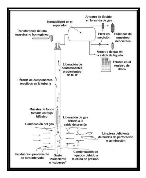
Figura 1-2 Fuentes de errores durante el muestreo de fluidos (Modificado de Petrowiki, 2015).
