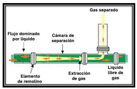
Figura 4-10 Esquema de un desgasificador en línea (Modificado de Schook et al., 2005).
