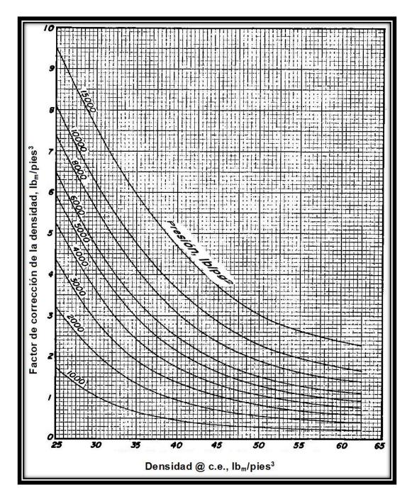
Figura 2-26 Gráfica de ajuste de la densidad por la compresibilidad de los líquidos del yacimiento (Modificado de McCain, 1990).
