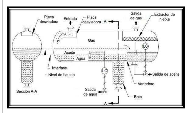
Figura 2-10 Separador horizontal con "bota" para líquido (Modificado de Arnold et al., 2008).
