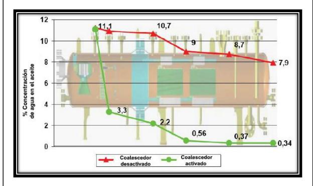
Figura 4-8 Concentración de agua en el aceite a lo largo del separador con y sin los elementos de coalescencia activados (Modificado de Chiesa et al., 2010).
