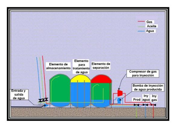
Figura 4-24 Unidad de separación y almacenamiento submarino para el Ártico (Modificado de Eie, 2015).
