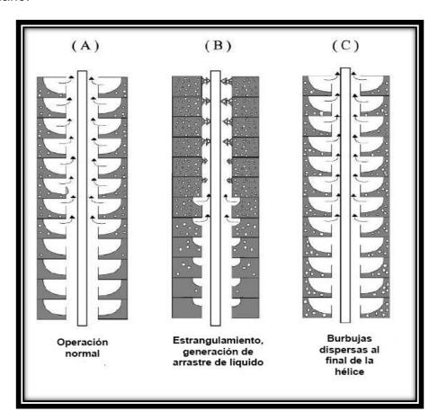
Figura 3-4 Separador secundario y sus condiciones de operación (Modificado de Rosa et al., 2001).
