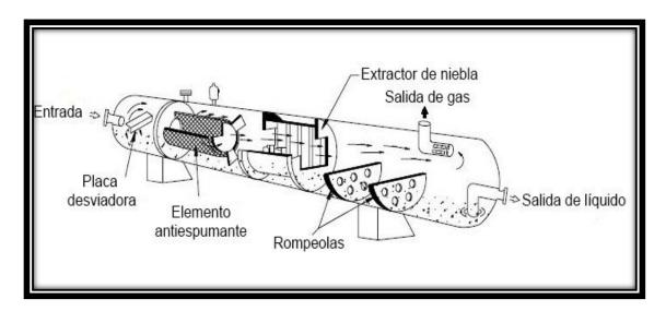
Figura 2-12 Elementos internos de un separador (Modificado de Arnold et al., 2008).
