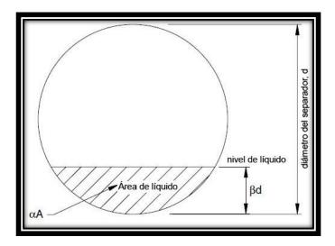
Figura 2-31 Separador con nivel de líquido diferente del 50% (Modificado de Arnold et al., 2008).
