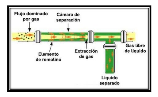
Figura 4-11 Esquema de un eliminador de líquido en línea (Modificado de Schook et al., 2005).
