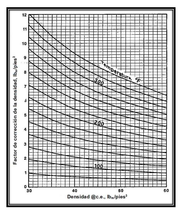
Figura 2-27 Gráfica de ajuste de la densidad por la expansión térmica de los líquidos del yacimiento (Modificado de McCain, 1990).
