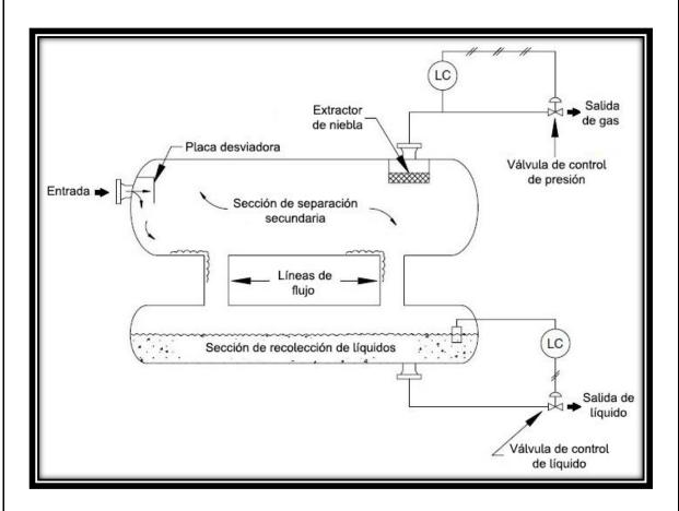
Figura 2-9 Secciones de un separador horizontal de dos barriles (Modificado de Arnold et al., 2008)
