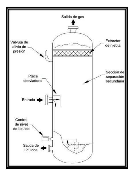
Figura 2-6 Esquema de un separador vertical (Modificado de Arnold et al., 2008).
