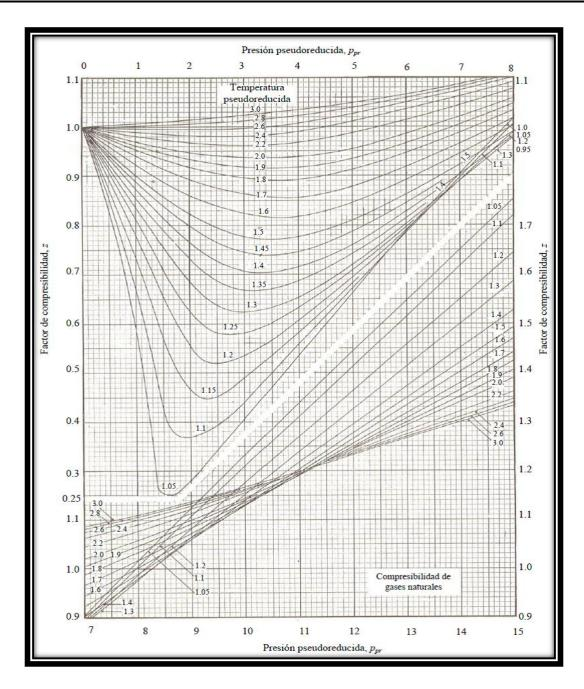
Figura 2-29 Factor de compresibilidad z, para gases naturales.
