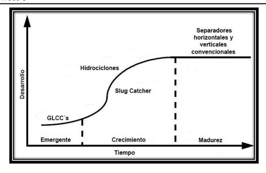
Figura 3-1 Curva de desarrollo de las tecnologías de separación (Modificado de Kouba et al., 1995).
