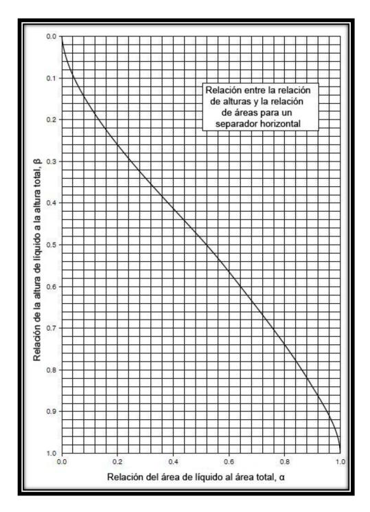
Figura 2-32 Constante de diseño: relación de áreas (α) vs. relación de alturas (β) para un separador horizontal bifásico lleno diferente de 50% de líquido (Modificado de Arnold et al., 2008).
