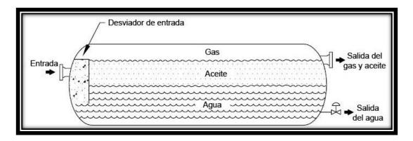
Figura 2-20 Esquema de un Free - Water Knockout horizontal (Modificado de Arnold et al., 2008).
