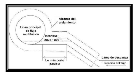
Figura 4-21 Esquema de la intersección entre una línea de descarga y la línea de flujo multifásico (Modificado de Greco et al., 2012).
