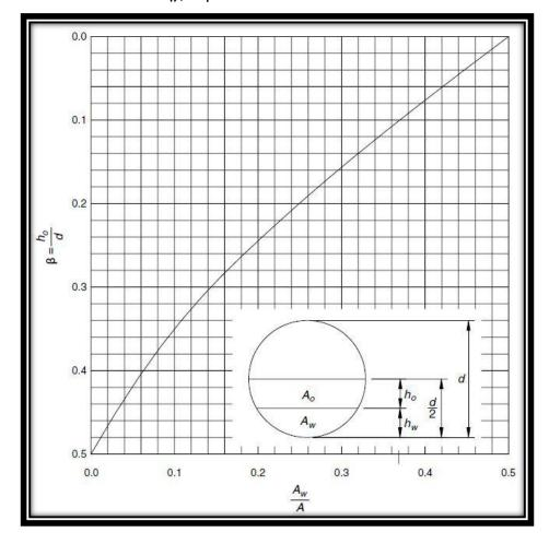
Figura 2-34 Coeficiente β para una vasija con nivel del líquido al 50% (Modificado de Arnold et al., 2008).
