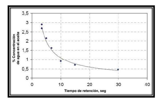
Figura 4-9 Calidad del aceite como función del tiempo de retención de la fase aceite en el DCEI – BCA (Modificado de Chiesa et al., 2010).
