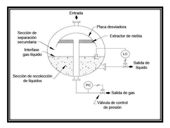
Figura 2-7 Esquema de un separador esférico (Modificado de Arnold et al., 2008).
