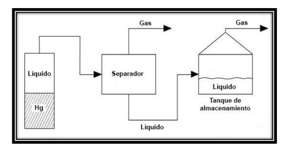
Figura 1-8 Representación esquemática de una prueba de separador (dos etapas).
