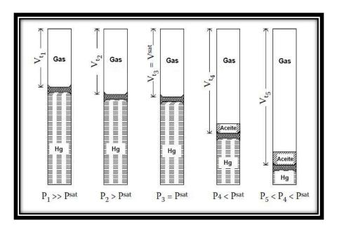
Figura 1-5 Representación del experimento PVT de expansión a composición constante (Modificado de Pedersen et al., 2007).
