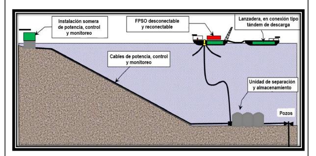
Figura 4-22 Esquema de desarrollo del sistema de separación submarina del Ártico (Modificado de Eie, 2015).
