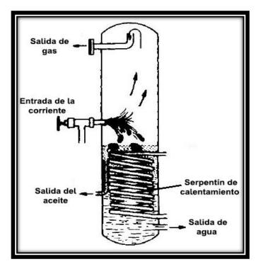
Figura 2-1 Esquema de separador a baja temperatura (Modificado de Szilas, 1986).
