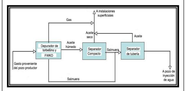
Figura 4-1 Proceso de separación compacto (Modificado de Wallace et al., 2008).
