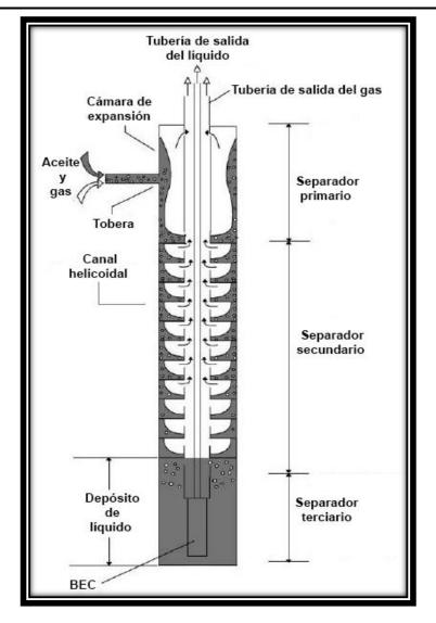
Figura 3-2 Diagrama de un separador ciclónico (Modificado de Rosa et al., 2001).
