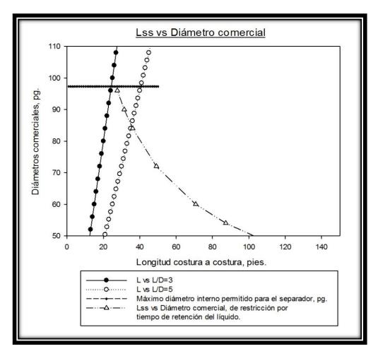
Sabiendo que el diseño está gobernado por la restricción por capacidad del tiempo de retención del líquido, la longitud efectiva del equipo debe ser:
