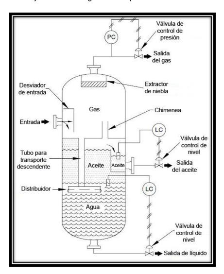
Figura 2-19 Esquema de un separador trifásico vertical (Modificado de Arnold et al., 2008).
