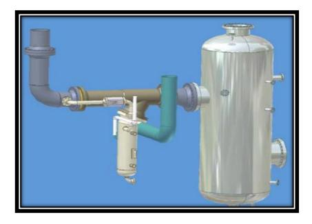
Figura 4-13 Eliminador de líquido corriente arriba del separador (Modificado de Schook et al., 2005).
