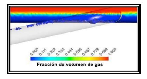
Figura 4-20 Fracción de volumen de gas en un punto abierto, tomado del resultado de la simulación (Modificado de Greco et al., 2012).
