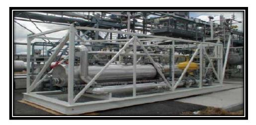
Figura 4-6 Esquema del separador de prueba con internos electrostáticos (Modificado de Chiesa et al., 2010).
