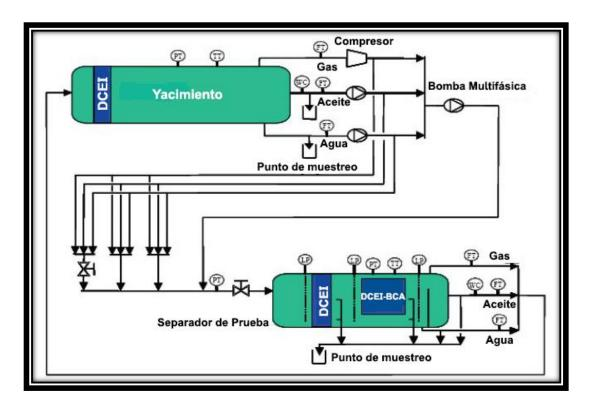
Figura 4-7 Diseño del circuito de prueba de Norsk Hydro (Modificado de Chiesa et al., 2010).
