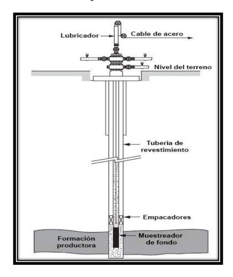
Figura 1-4 Esquema del muestreo de fondo (Modificado de Heriot – Watt Univ., 2012).
