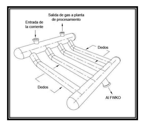
Figura 2-8 Esquema de un Slug catcher (Modificado de Arnold et al., 2008).
