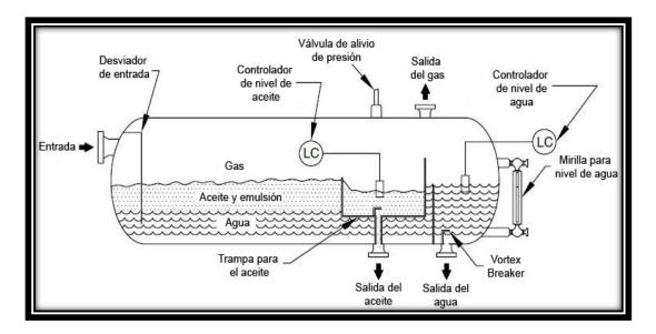
Figura 2-18 Separador trifásico horizontal tipo "trampa y vertedero" (Modificado de Arnold et al., 2008).
