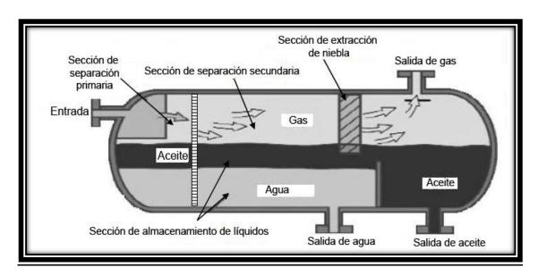
Figura 2-4 Principales secciones de un separador (Modificado de Lu, Greene y Agrawal, 2009).
