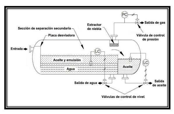
Figura 2-5 Esquema de un separador horizontal trifásico (Modificado de Arnold et al., 2008).
