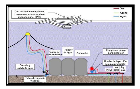
Figura 4-25 Producción con FPSO desconectado (Modificado de Eie, 2015).
