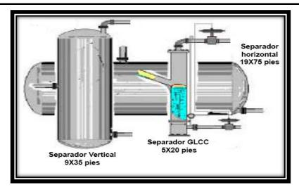
Figura 3-7 Comparación entre las dimensiones de separadores (Modificado de Gomez et al., 2000).
