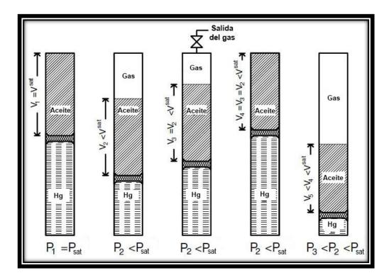
Figura 1-7 Representación del experimento PVT de separación diferencial (Modificado de Pedersen et al., 2007).
