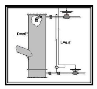
Figura 3-11 Separador ciclónico cilíndrico como separador primario (Modificado de Gomez et al., 2000).
