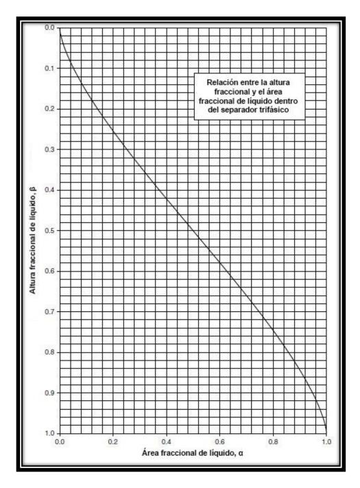
Figura 2-35 Constante de diseño por restricción por tiempo de retención para un separador trifásico horizontal con un nivel de líquido diferente del 50% (Modificado de Arnold et al., 2008).
