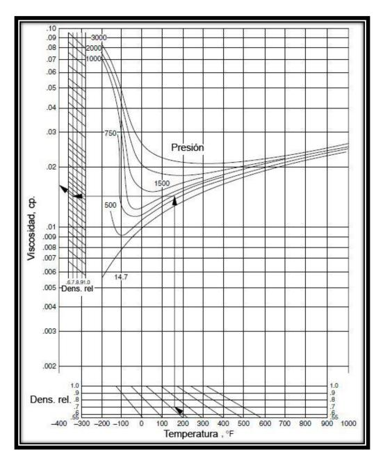
Figura 2-30 Viscosidad del gas hidrocarburo (Modificado de Arnold et al., 2008).
