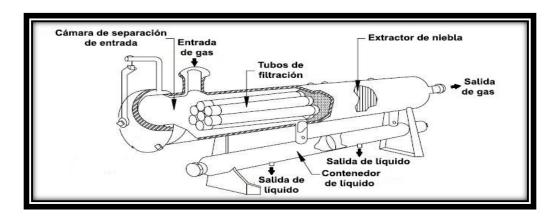
Figura 2-3 Esquema de un depurador (Modificado de Arnold et al., 2008).
