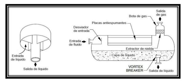
Figura 2-13 Vortex breaker y su ubicación en un separador (Modificado de Arnold et al., 2008).
