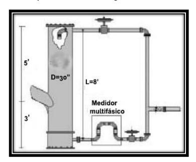
Figura 3-9 Circuito de medición multifásico con separador GLCC y medidor multifásico (Modificado de Gomez et al., 2000).
