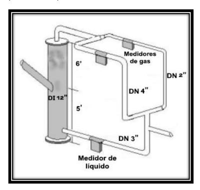
Figura 3-8 Circuito de medición multifásico con separador GLCC y medidores monofásicos (Modificado de Gómez et al., 2000).
