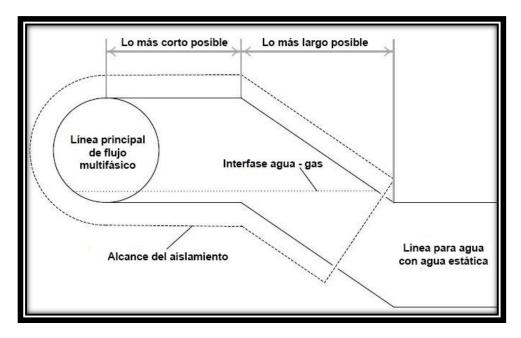
Figura 4-19 Esquema de la intersección entre la línea de flujo multifásico y la línea de cruce de tuberías (Modificado de Greco et al., 2012).
