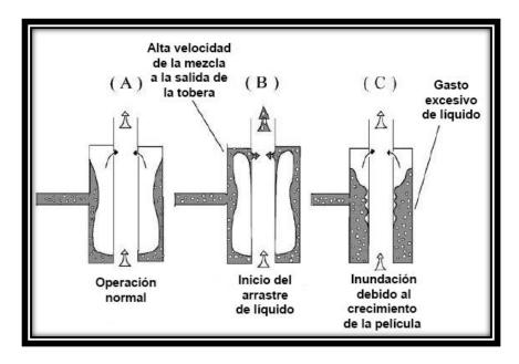
Figura 3-3 Cámara de expansión y sus condiciones de operación (Modificado de Rosa et al., 2001).
