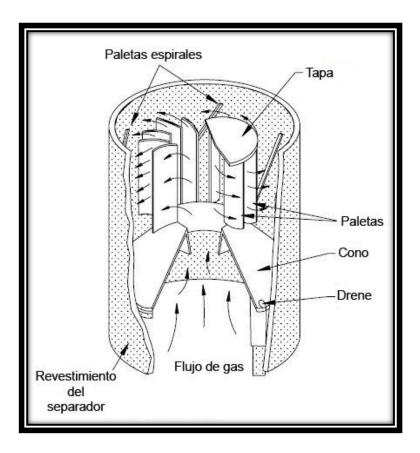
Figura 2-17 Extractor de niebla centrífugo (Modificado de Arnold et al., 2008).
