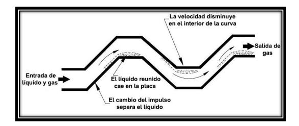
Figura 2-15 Esquema de funcionamiento de los deflectores (Modificado de Arnold et al., 2008).
