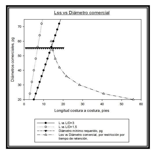
Con base en la gráfica, entre las rectas de relación de esbeltez (1.5 - 3), existe un punto únicamente y que es la solución al problema: se requiere un separador de 60 pulgadas de diámetro interno, con una longitud de 13.85 pies de longitud (altura). Con ayuda de catálogos comerciales, la elección que se hace es de un separador vertical trifásico de 60 pg. de diámetro interno por 15 pies de altura.
