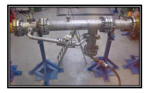
Figura 4-14 Eliminador de líquido de la plataforma Sleipner – T (Modificado de Schook et al., 2005).
