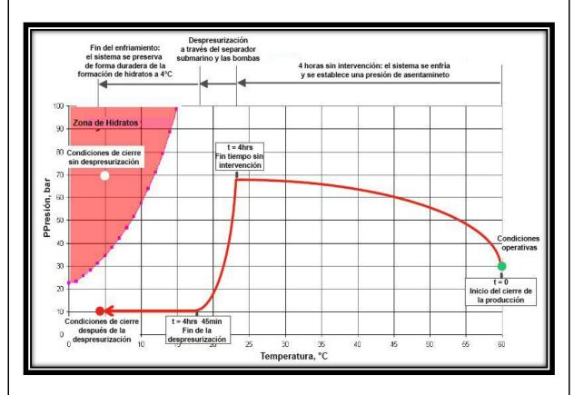
Figura 4-4 Prevención de la formación de hidratos mediante la despresurización (Modificado de Bon, 2009).
