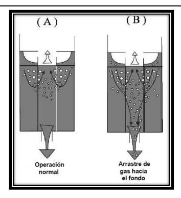
Figura 3-5 Separador terciario y sus condiciones de operación (Modificado de Rosa et al., 2001).
