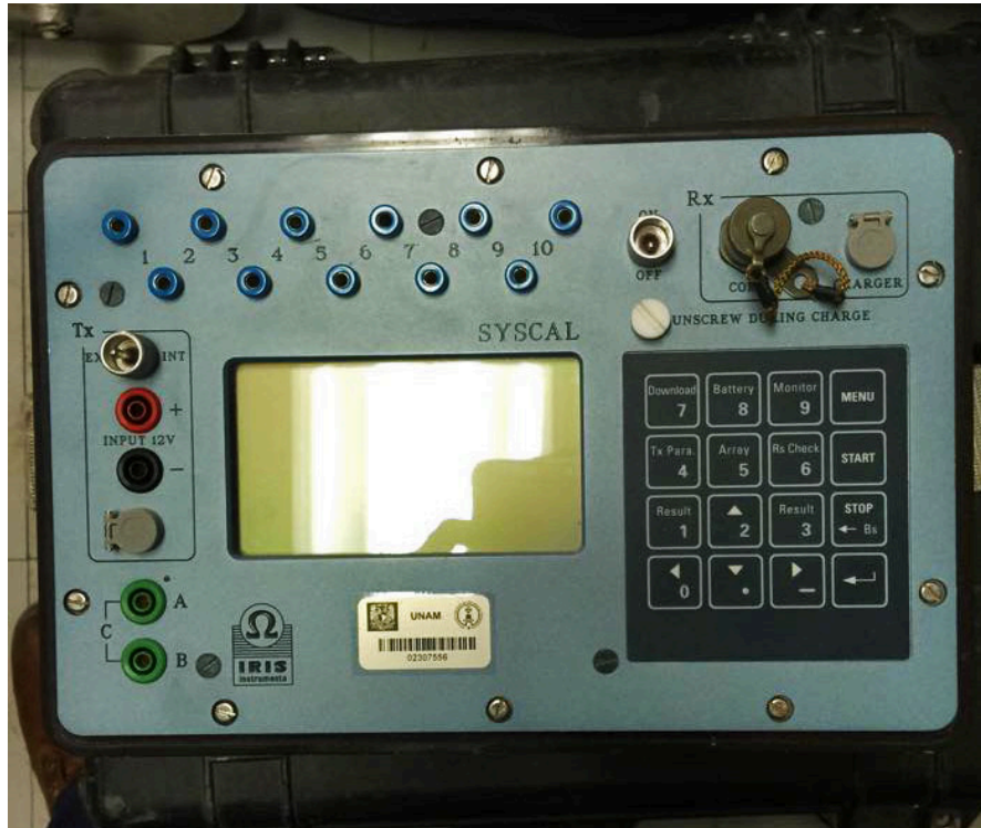
Figura 5.3.- Equipo utilizado para la ERT Syscal Pro de Iris Instruments .
