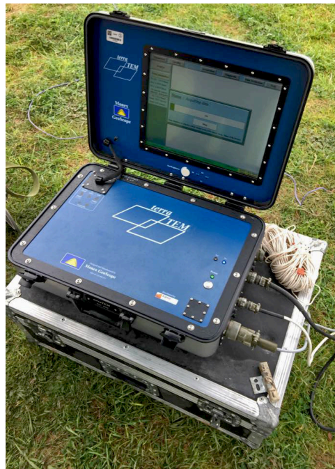
Figura 5.1 .- Equipo terraTEM utilizado para la adquisición de datos transitorios.
