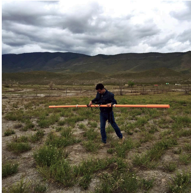
Figura 5.5.- Adquisición de datos con el método electromagnético de bajo número de inducción (EMI) con el equipo CMD-4 de GF Instruments
