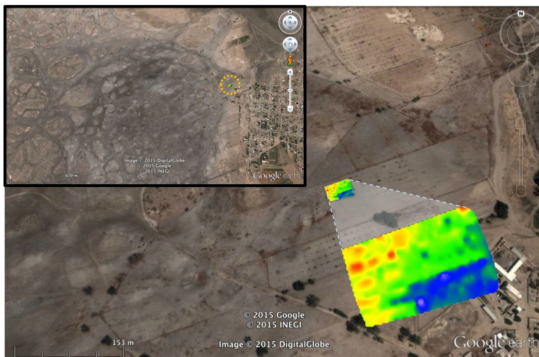
Figura 6.12.- Sobreposición de los datos de la respuesta en fase obtenidos con la configuración CMD-4 en el terreno donde se realizó el estudio (Google Earth, 2015).
