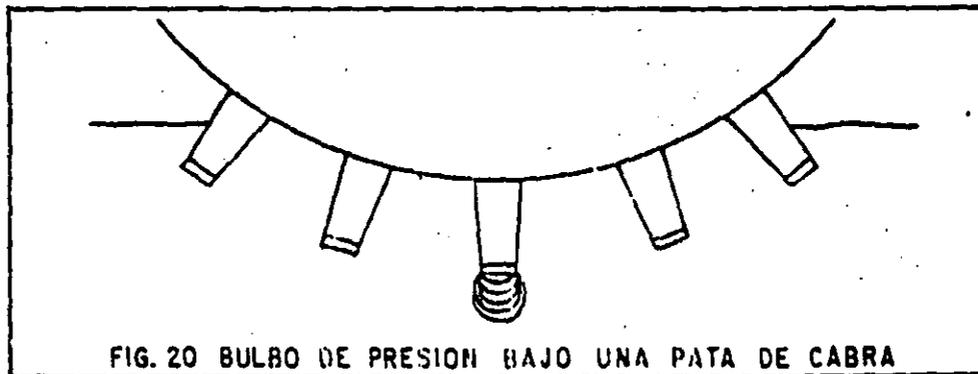
FIG. 20 BULBO DE PRESION BAJO UNA PATA DE CABRA
