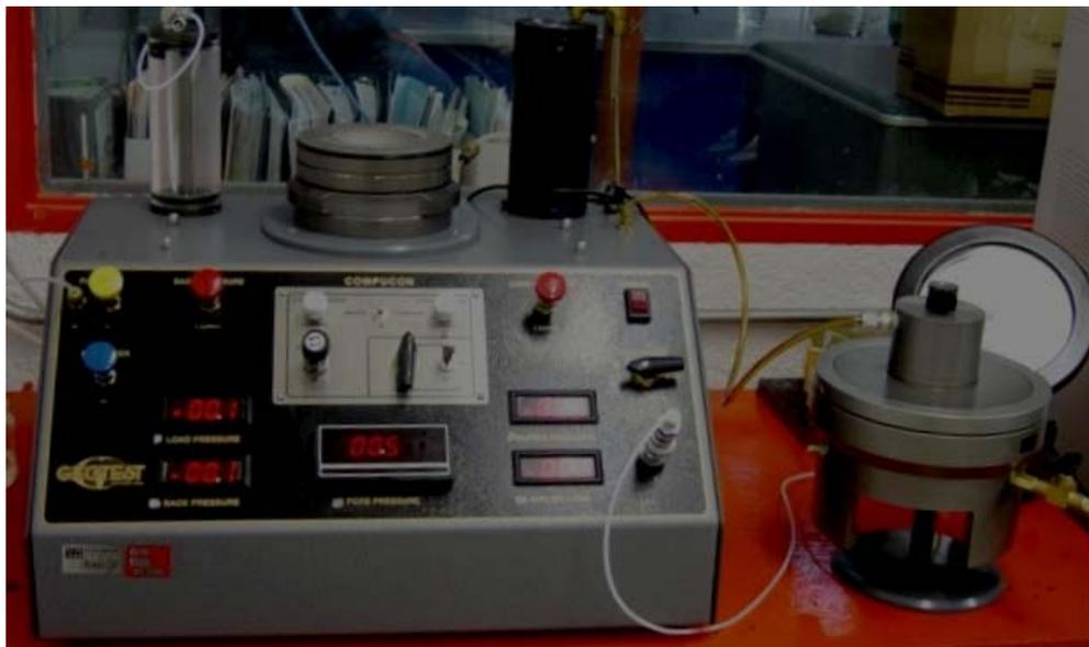
Figura 3.3 Equipo de consolidación neumático
