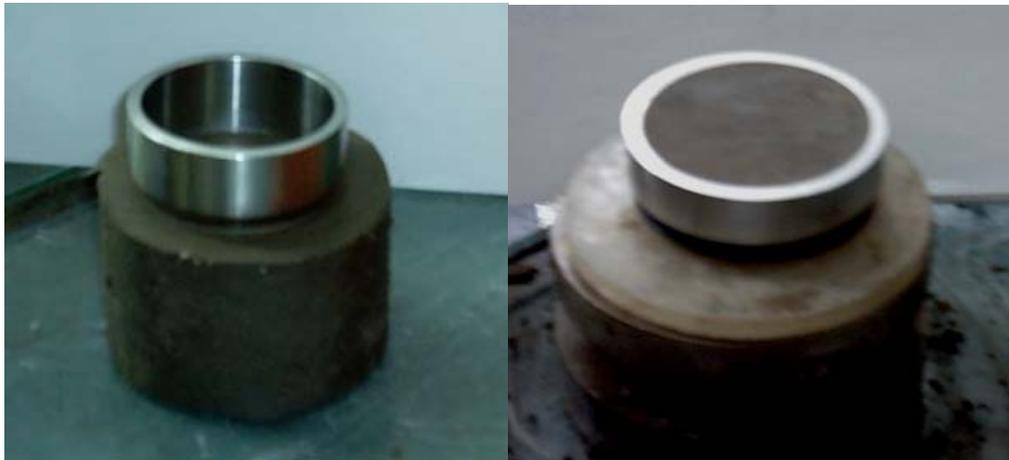
Figura 3.5 Labrado de la probeta
