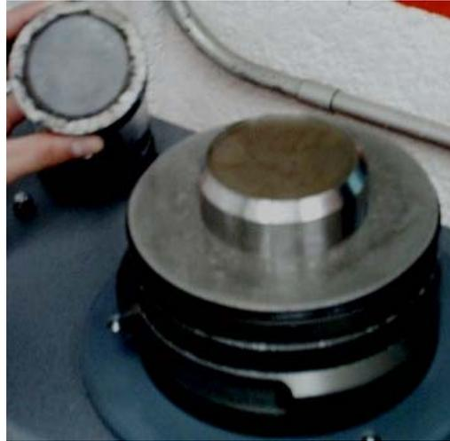
Figura No. 3.6 Ubicación de la probeta en el consolidómetro
