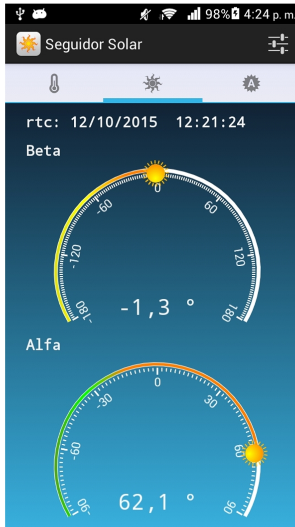
Figura 2.15. Pantalla principal de la aplicación “Seguidor solar”.
