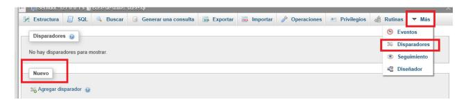
Figura 4.2.8 Creación de un trigger
