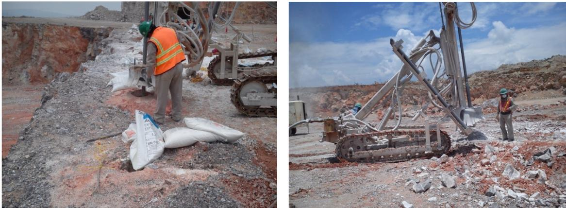
Ilustración 20. Perforación con Track Drill
