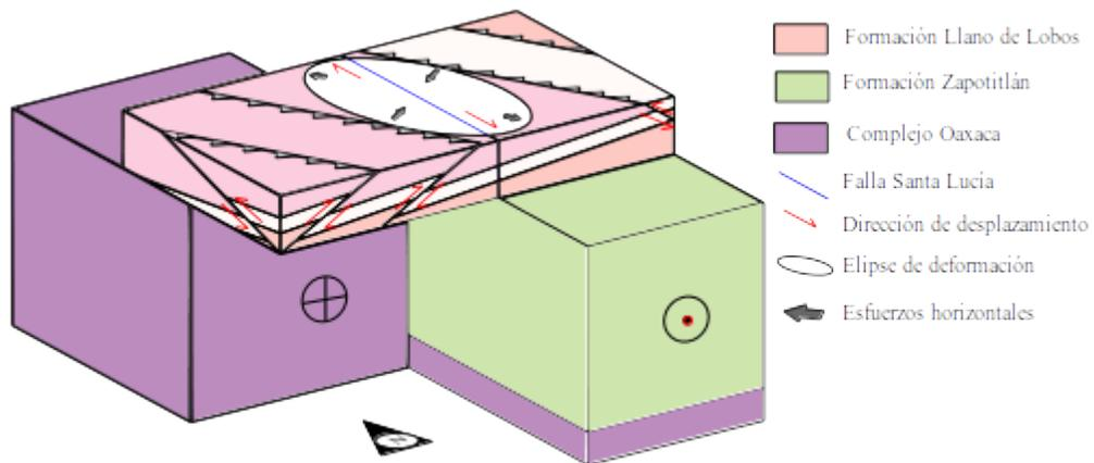
*Figura 15: Modelo Conceptual que ejemplifica el arreglo de las fallas inversas observadas en la Sección Escorial como respuesta a la reactivación de la Falla Santa Lucía como falla lateral derecha hacia el Oligoceno Temprano.*
