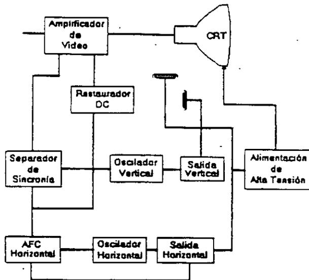
El flyback nos proporciona las tensiones para las rejillas de aceleración y foco del CRT
