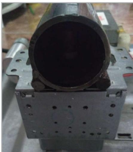
**Figura 26.** Magnetrón 900 [MHz] con modificación en la guía de ondas.
