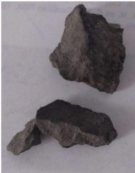
**Figura 31.** Muestra M5 fracturada con una cantidad menor de energía por efecto de la irradiación.
