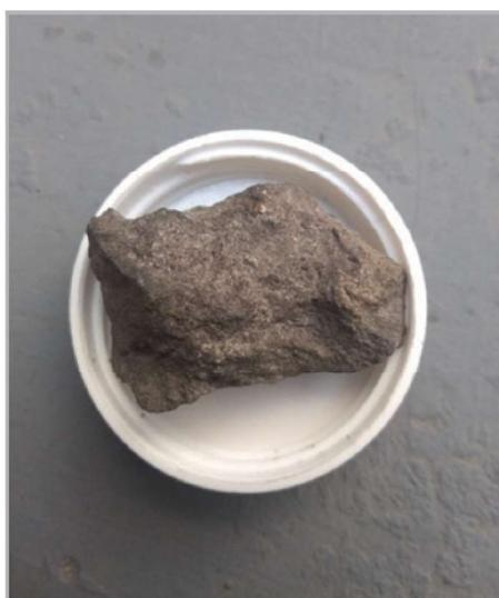
**Figura 28.** Muestra M5 antes de ser irradiada por las microondas.
