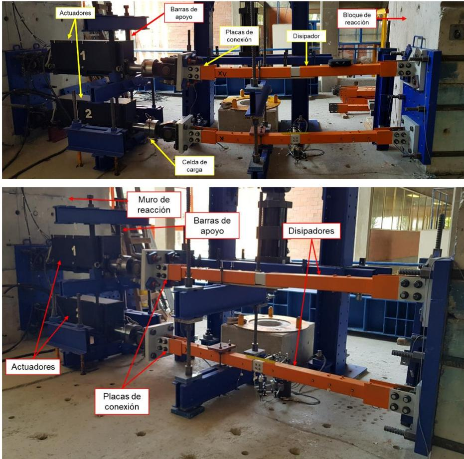
**Figura 3.9:** Fotografías del arreglo experimental.
