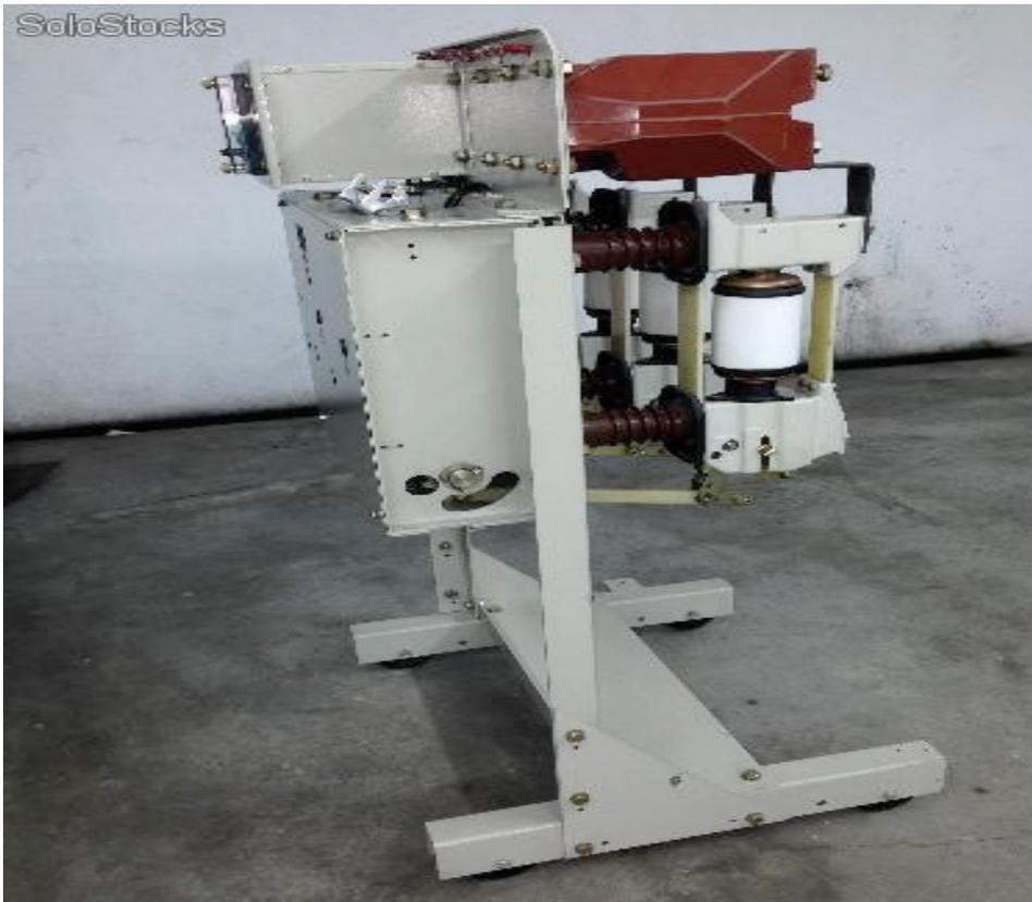
Fig. anexo b.1. Interruptor de vacío, vista lateral, fuera de servicio.
