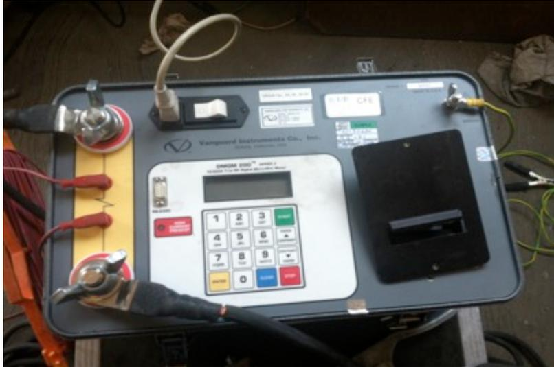
Fig. 6.1.5.a. Equipo para realizar la prueba de Resistencia de Contactos (Ducter). Marca: Vanguard Instrument. Modelo: DMOM 200.
