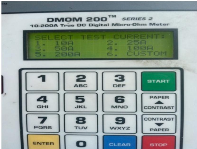
Fig. 6.6.1.g. Pantalla para seleccionar el amperaje deseado.
