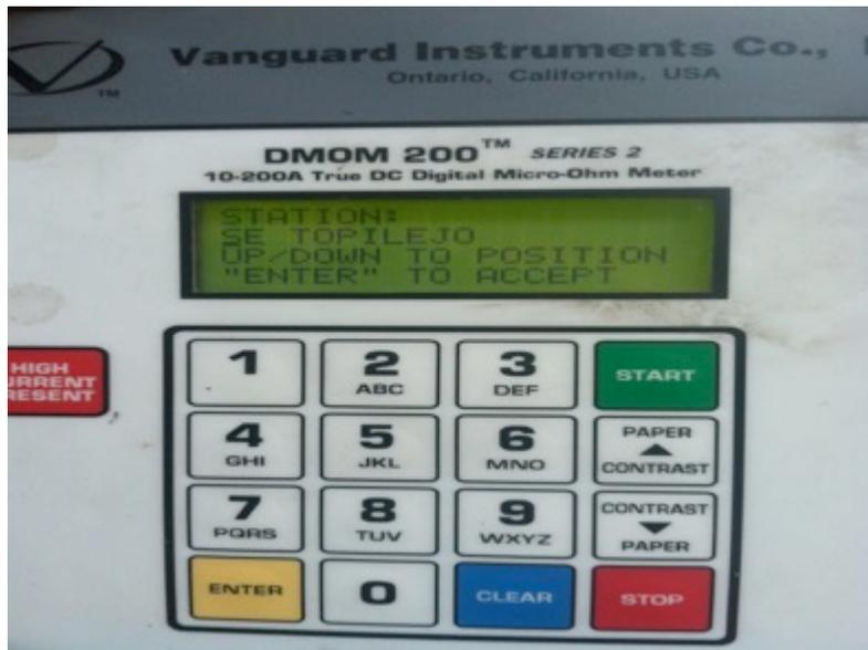
Fig.6.6.1.e. Seguimiento de programación del equipo de prueba, nombre de la Subestación.
