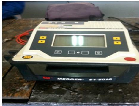
Fig. 6.1.a. Equipo para realizar la prueba de Resistencia de Aislamiento. Marca: AVO Megger. Modelo: S1-5010.
