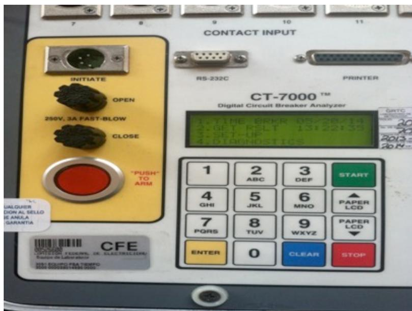
Figura 6.1.4.a. Equipo para realizar prueba de Sincronismo y Tiempos de Operación. Marca: Vanguard Instrument. Modelo: CT-7000.
