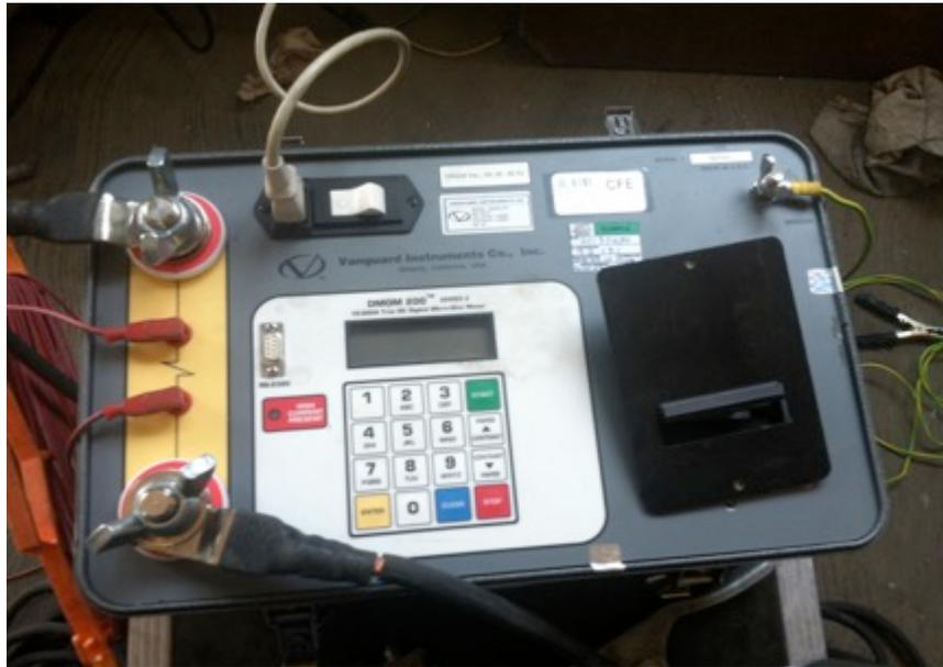
Fig. 6.6.1.a. Equipo de Prueba de Resistencia de Aislamiento (Ducter).
