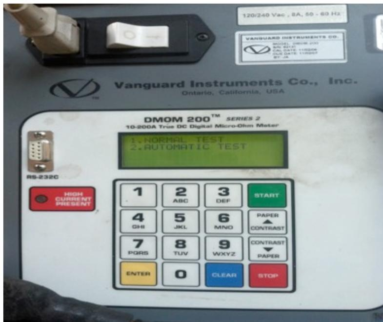
Fig. 6.6.1.f. Pantalla para seleccionar la prueba.
