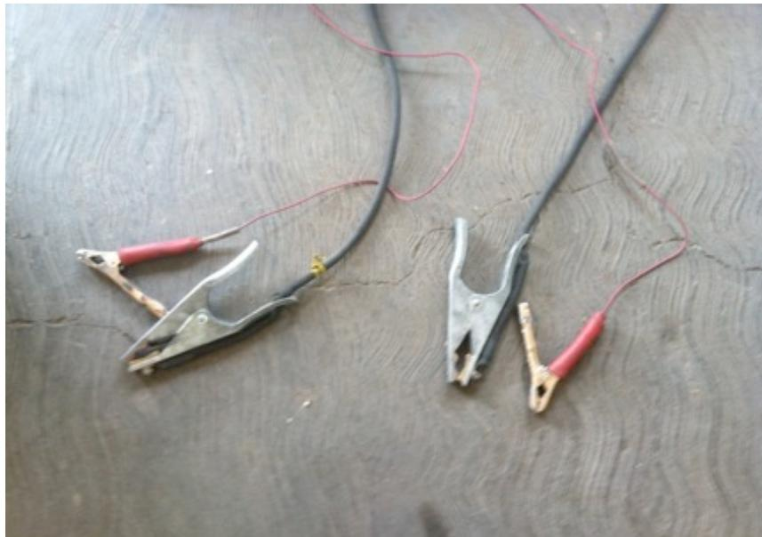
Fig. 6.6.1.b. Cables de Conexión de Potencial (rojos) y de Corriente (negros).
