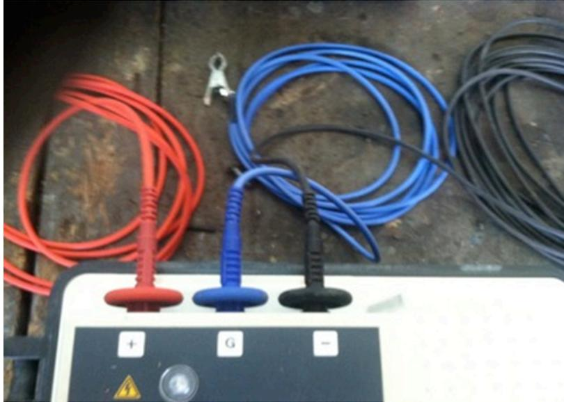
Fig. 6.1.b. Conexiones del Equipo Megger.
