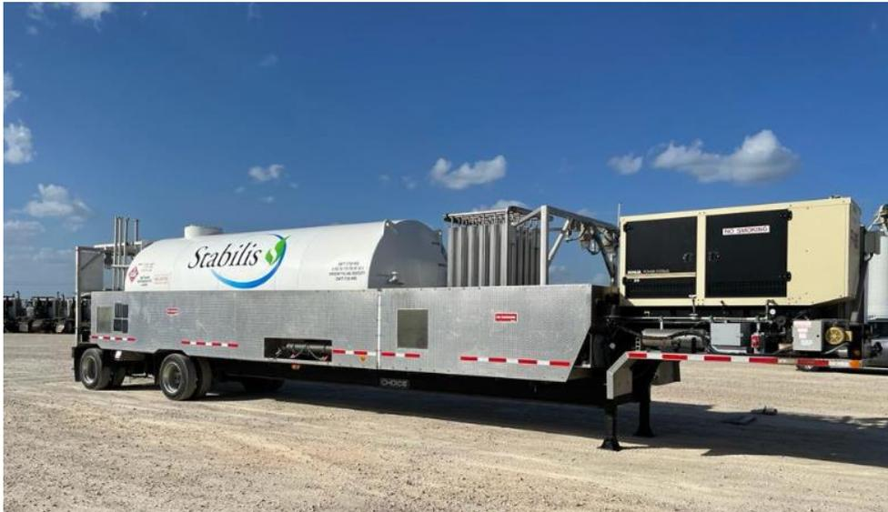
Figura 10. Vista lateral de un equipo Fueler Pawn.
