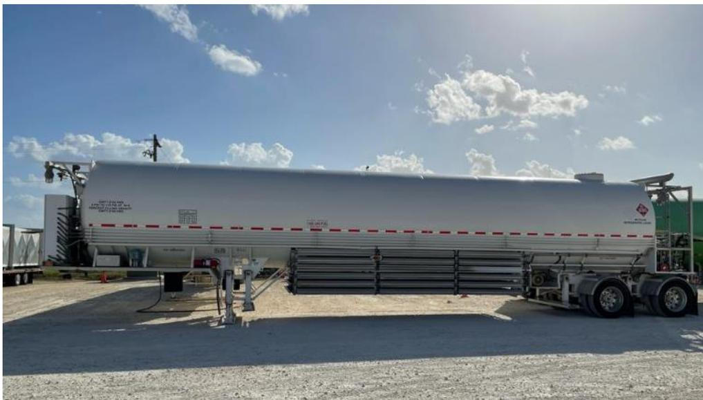
Figura 11. Vista lateral de un equipo Fueler Queen.
