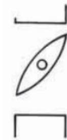
Figura 1.6. Esquema válvula de mariposa [14].
