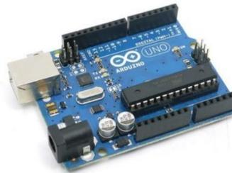
Figura 4.4.- Placa Arduino UNO
