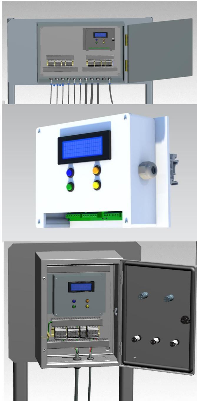
*Figura 4.21.-Modulo de control y posición en el gabinete eléctrico*
