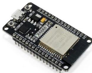
Figura 4.5.-Módulo ESP32 WROOM 32
