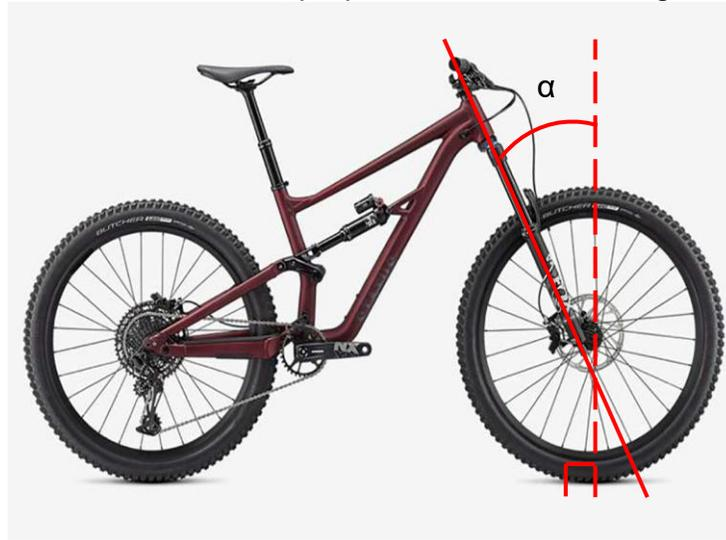
Figura A1 – Ángulo de lanzamiento  $\alpha$  sobre una bicicleta [45]
