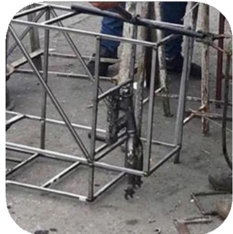
Figura 2.19 – Modificación de una horquilla de bicicleta 20\"/>
