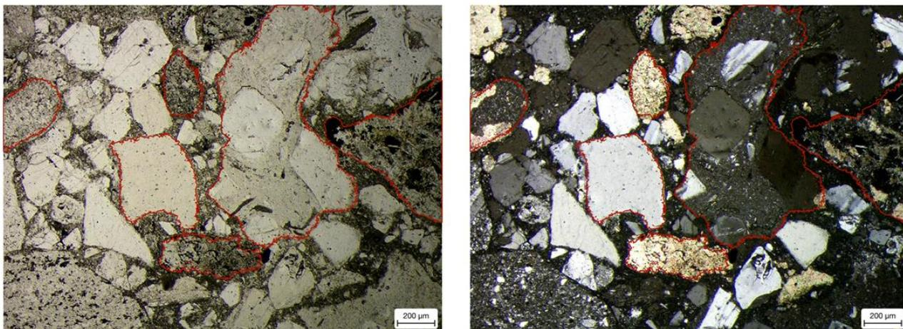
*Figura 43. Muestra PRZ-003-19-01 con cristaloclastos de cuarzo (Qz), clastos ígneos y clastos con reemplazamientos de carbonatos. Imágenes de microscopía petrográfica de luz transmitida con, nicols paralelos, nicols cruzados junto a un diagrama de la muestra.*
