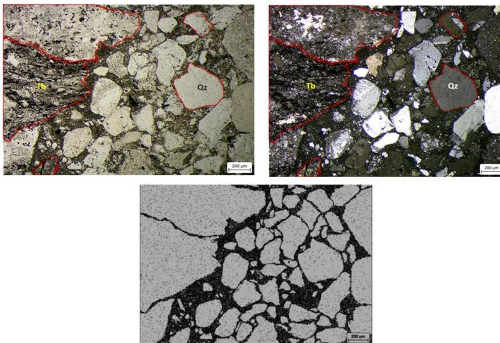
*Figura 44. Muestra PRZ-003-19-02 con cristaloclastos de cuarzo (Qz), clastos de toba (Tb) y clastos con reemplazamientos de carbonatos. (Cz). Imágenes de microscopía petrográfica de luz transmitida con, nicols paralelos, nicols cruzados junto a un diagrama de la muestra.*
