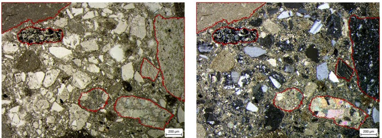
*Figura 40. Muestra PRZ-003-16-01, caliza(cal), calcita (Cb), clasto re-brechado (RBrch), clasto con destrucción textura (Cdst), pasta microlítica (Pm). Imágenes de microscopía petrográfica de luz transmitida con, nicoles paralelos, nicoles cruzados junto a un diagrama de la muestra.*
