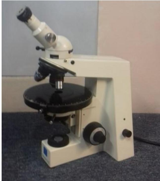
*Figura 38. Microscopio petrográfico ZEISS-Primotech*
