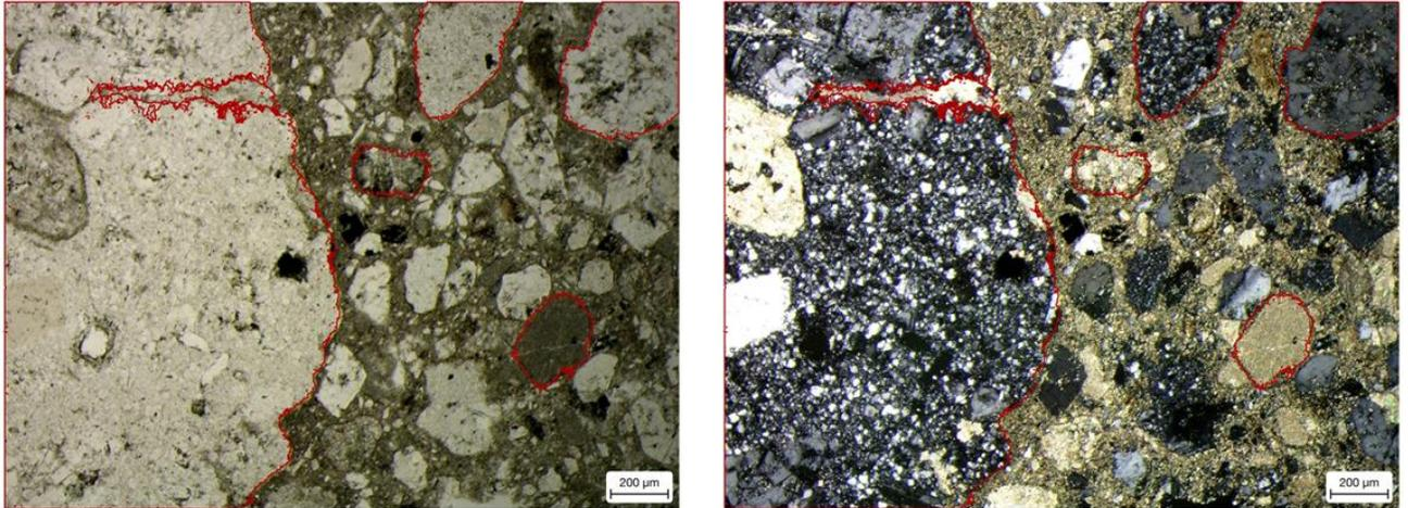
*Figura 45. Muestra PRZ-004-15-02 con cristaloclastos de Qz y Plg, clastos de dacita (Dac), clastos de Caliza (Cz) y clastos con reemplazamientos de carbonatos. (Cz). Imágenes de microscopía petrográfica de luz transmitida con, nicols paralelos, nicols cruzados junto a un diagrama de la muestra.*
