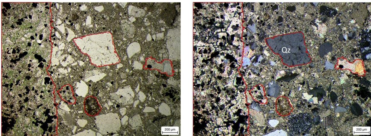
*Figura 42. Muestra PZR-03-16-02 con halos de alteración propilitica, cristaloclastos de cuarzo (Qz), clastos de caliza tipo mudstone, clastos con reemplazamientos de carbonatos. Imágenes de microscopía petrográfica de luz transmitida con, nicoles paralelos, nicoles cruzados junto a un diagrama de la muestra.*
