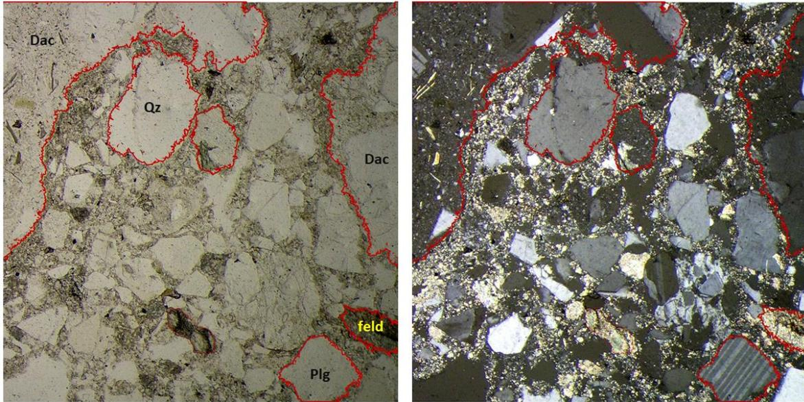
*Figura 47. Muestra PRZ-004-18-03 con cristaloclastos de cuarzo (Qz), feldespatos potásicos (feld) y plagioclasas(Plg), clastos de dacita (Dac), clastos alterados(Cz). Imágenes de microscopía petrográfica de luz transmitida con, nicoles paralelos, nicoles cruzados.*
