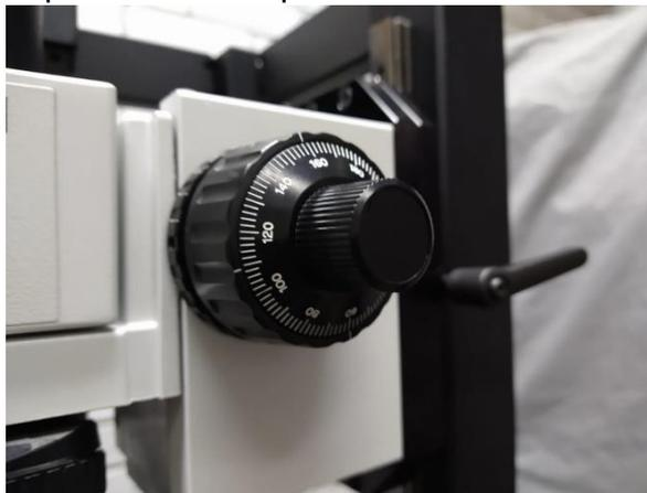
**Figura 50.** Perillas para enfocar el microscopio
