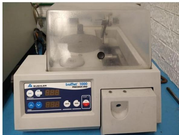
**Figura 54.** Cortadora de disco.
