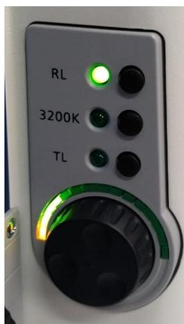
**Figura 30.** Controlador de intensidad de luz.
