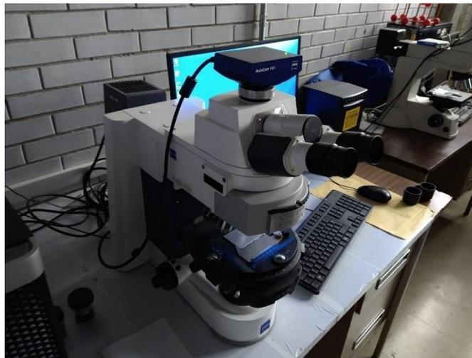
**Figura 28.** Microscopio óptico y cámara.
