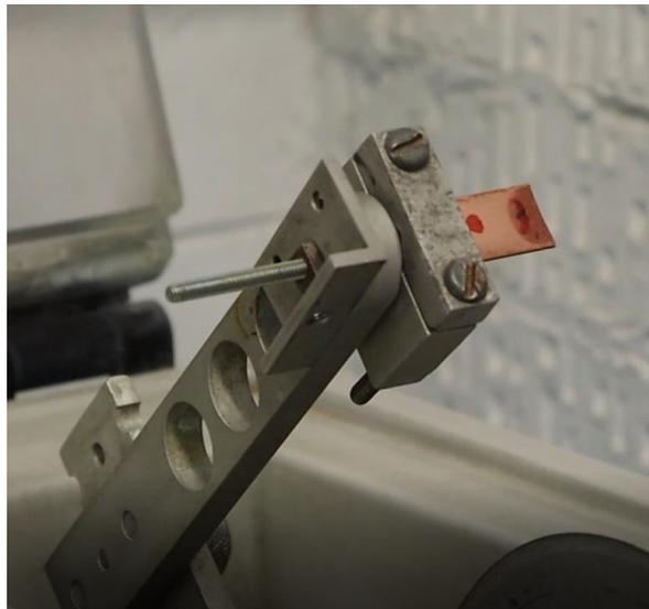
**Figura 57.** Muestra colocada en el portamuestras de la cortadora.
