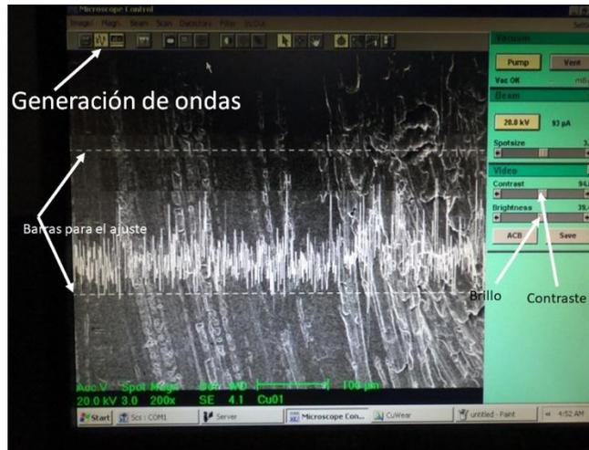
**Figura 41.** Diagrama para el ajuste de contraste y brillo.
