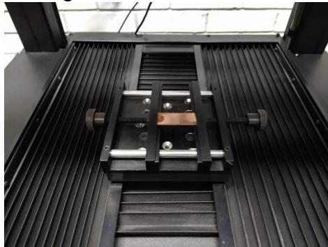
**Figura 47.** Muestra colocada sobre el portamuestra del perfilómetro.
