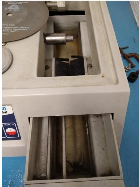
**Figura 55.** Bandeja con agua para lubricar el disco.
