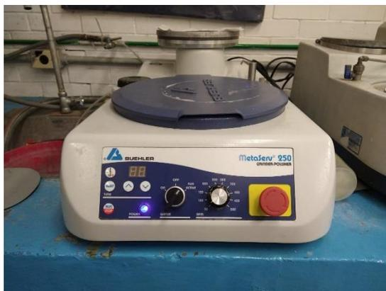
**Figura 13.** Pulidora MetaServ 250® usada para la preparación de la muestra
