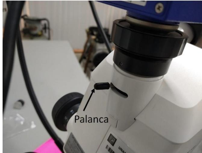
**Figura 24.** Palanca para destapar la cámara.
