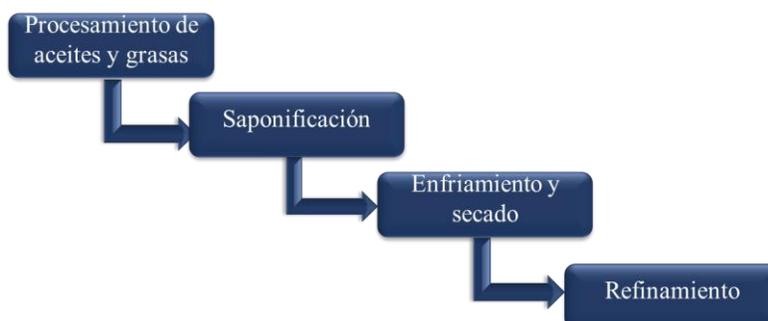
*Ilustración 7 Manufactura del jabón en cuatro pasos*
