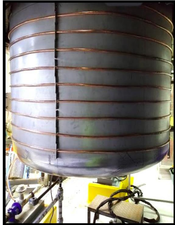
*Ilustración 55 Colocación de traza de vapor*
