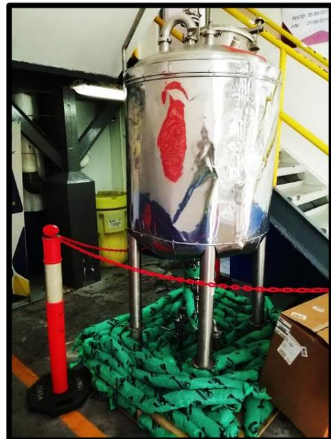
*Ilustración 40 Tanque provisional delimitado con medidas de seguridad*
