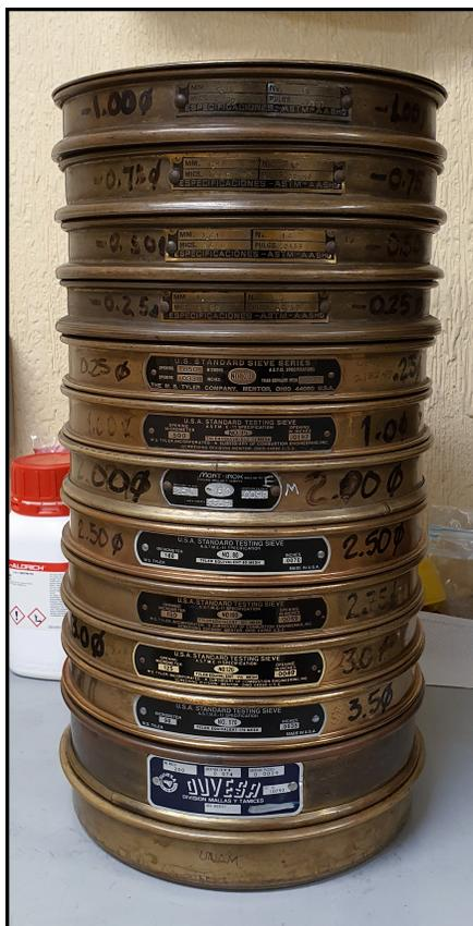
Se pesaron los sedimentos que quedaron atrapados en las diferentes mallas y, con estos pesos, poder sacar su porcentaje respecto al peso original. Para evitar la contaminación de las muestras, se limpió el material utilizado y el área de trabajo entre cada cambio de muestra.
