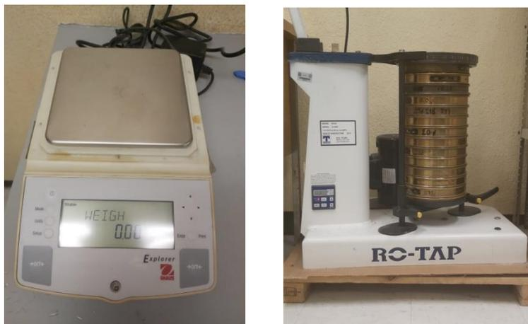
*Figura 13. (Izquierda) Balanza analítica, (derecha) Ro-TAP. Laboratorio de Sedimentología ICMyL, UNAM.*
