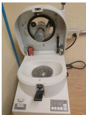
*Figura 17. Molino automático Fritsch Pulverisette. Laboratorio de Sedimentología ICMyL, UNAM.*
