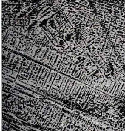
Fig. 18 Microestructura de un Hierro blanco a 20x (5).
