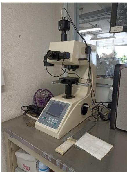
*Fig. 25 Micro durómetro Digital Vickers modelo HVS-1000*
