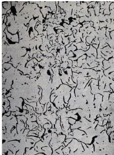
Fig. 20 Microestructura del hierro gris (5).
