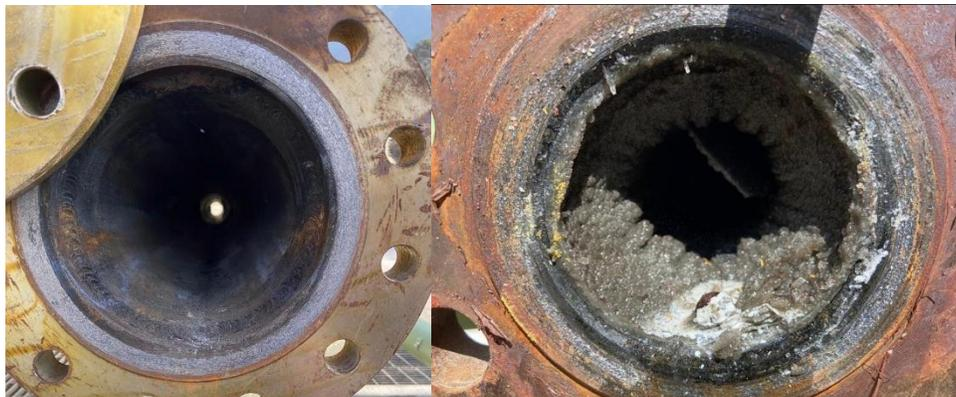
Figura 87. Incrustación y precipitación de sílice.
