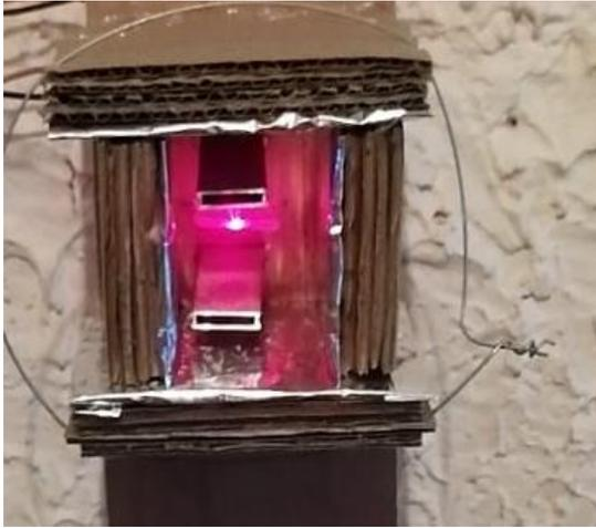
*Ilustración 1 Prueba para medir la temperatura que alcanzan las placas térmicas. Cámara elaborada de cartón como material aislante con cubierta interior de aluminio para reflejar el calor emitido por las dos placas térmicas, al centro se encuentra la tira de acrílico siendo medida en su temperatura por un termómetro laser.*
