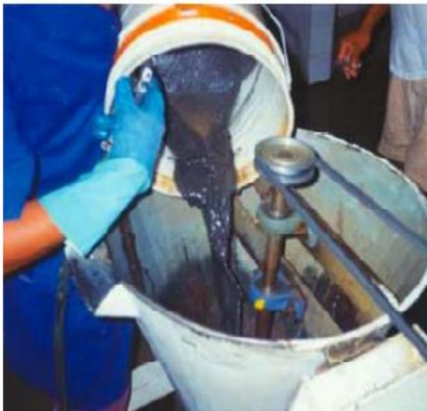
Figura 23 Introducción de concentrado en batidora (Global Mercury Project, 2006)
