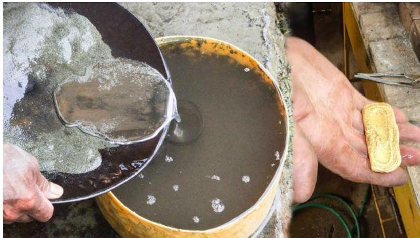
Figura 22 Introducción de mercurio para obtener una amalgama Au-Hg (Global Mercury Project, 2006)
