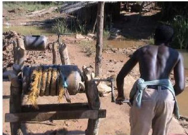
*Figura 14 Molino de bolas accionado manualmente en Mozambique (Global Mercury Project, 2006)*
