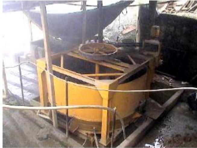
*Figura 12 Molino chileno usado por mineros ecuatorianos (Global Mercury Project, 2006)*
