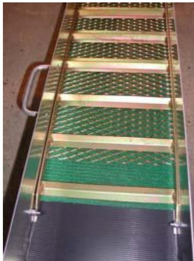
Figura 19 Rifles en sección (Global Mercury Project, 2006)
