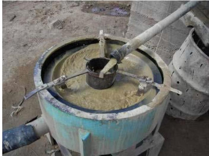
Figura 20 Concentrador centrífugo para concentración gravimétrica (Global Mercury Project, 2006)
