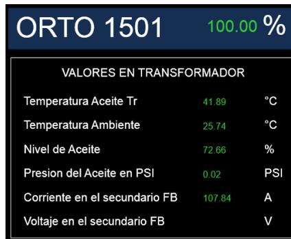
Figura 2.17. Plantilla de valores de medición del ORTO 1501 en el SurvalentONE
