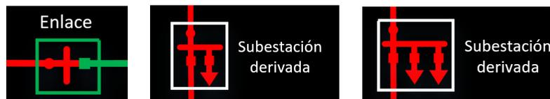
Figura 2.3. Seccionadores de enlaces y subestaciones generales
