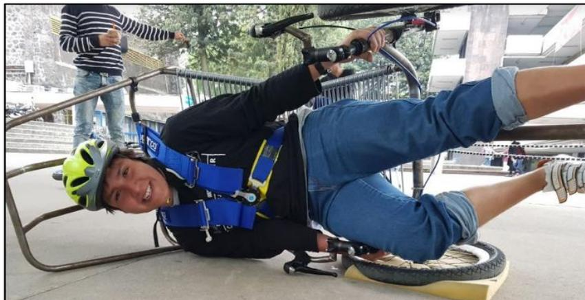
Imagen.3.8 Prueba física de volcadura de 90°. Recuperado de la base de datos del equipo Velomóvil RS.
