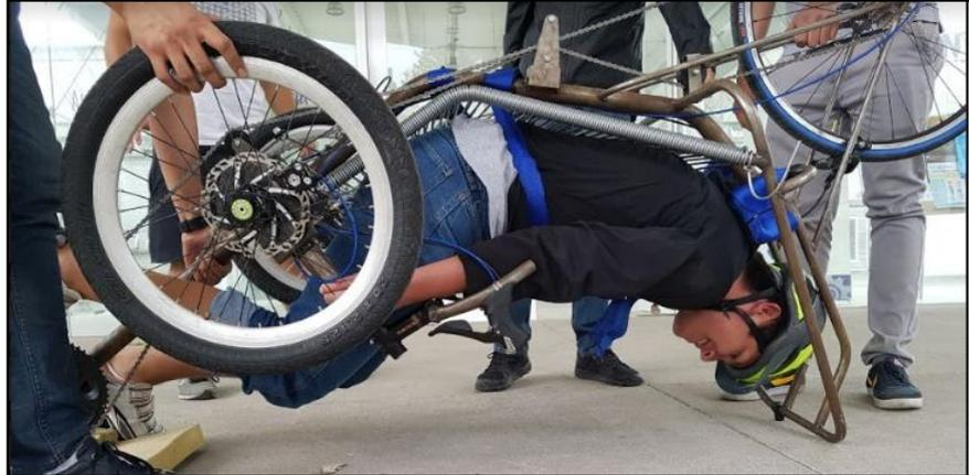
Imagen.3.7 Prueba física de volcadura de 180°. Recuperado de base de datos del equipo Velomóvil RS.
