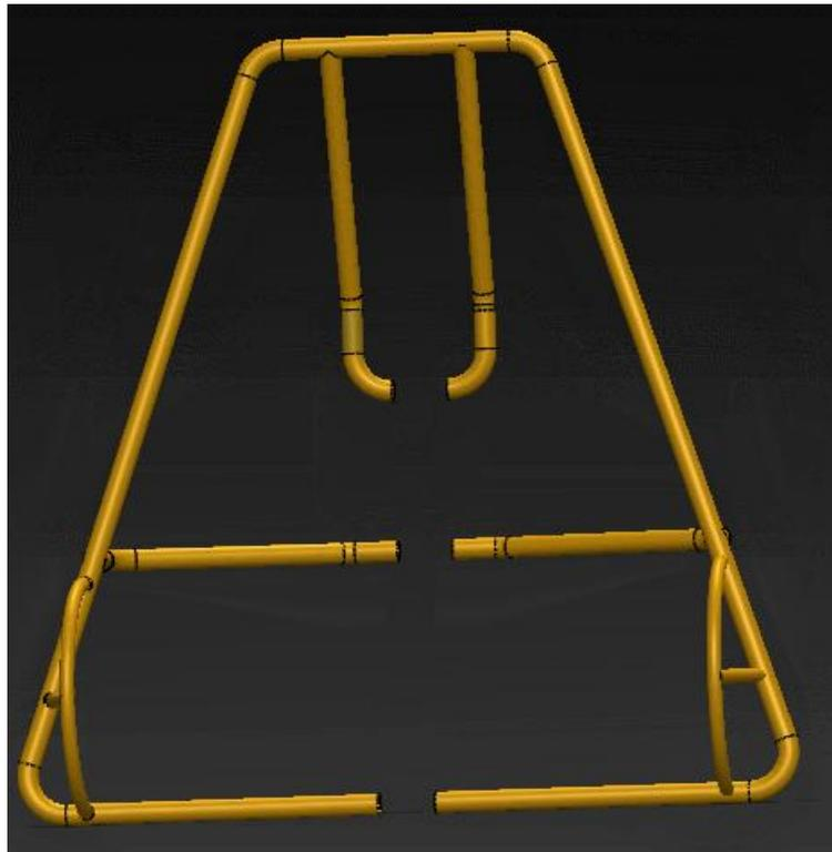
Imagen 5.3 Modelo completo de *rollbar* con delimitadores en SolidWorks. Recuperado de la base de datos del equipo Velomóvil RS.
