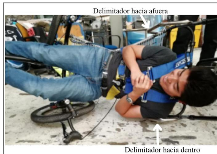
Imagen 4.6 Prueba de volcadura 90 [°] con delimitador hacia afuera. Recuperado de base de datos del equipo Velomóvil RS.
