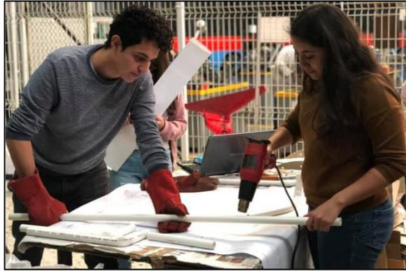
Imagen 3.12 Manufactura de modelo de PVC. Recuperada de la base de datos del equipo Velomóvil RS.
