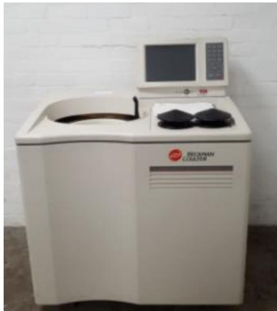
Figura 77. Ultracentrífuga
