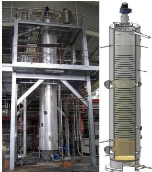
*Figura 240. Torre de lavado para el proceso de saponificación (Flores, 2017).*
