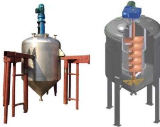
*Figura 239. Reactor de saponificación*
