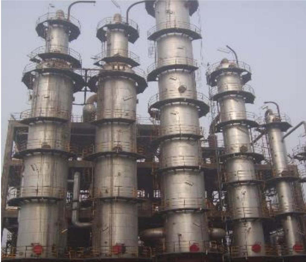
*Figura 153. Columnas de fraccionamiento continuo con rectificación*
