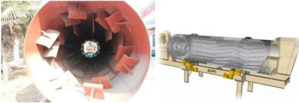
*Figura 100. Interior de un secador rotatorio*
