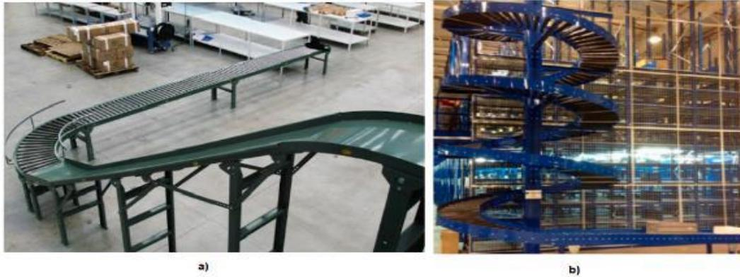
Figura 49. Transportadores por gravedad de a) Plano inclinado y b) Espiral
