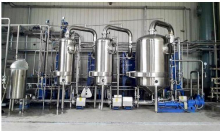
*Figura 86. Evaporador de efecto múltiple*
