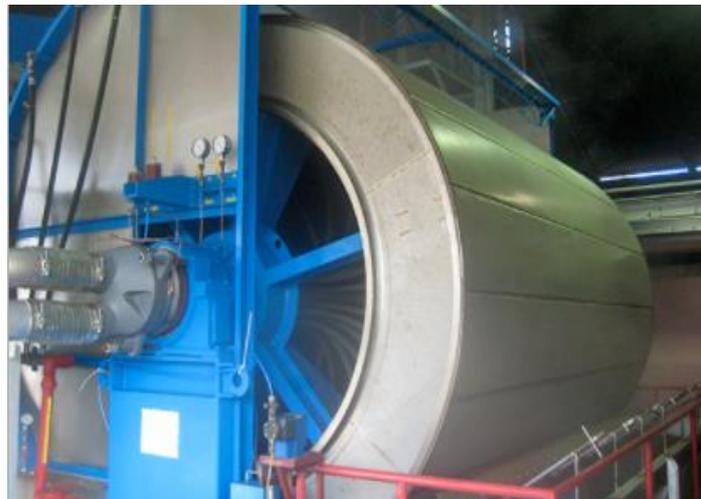
*Figura 34. Filtro continuo rotatorio a vacío*
