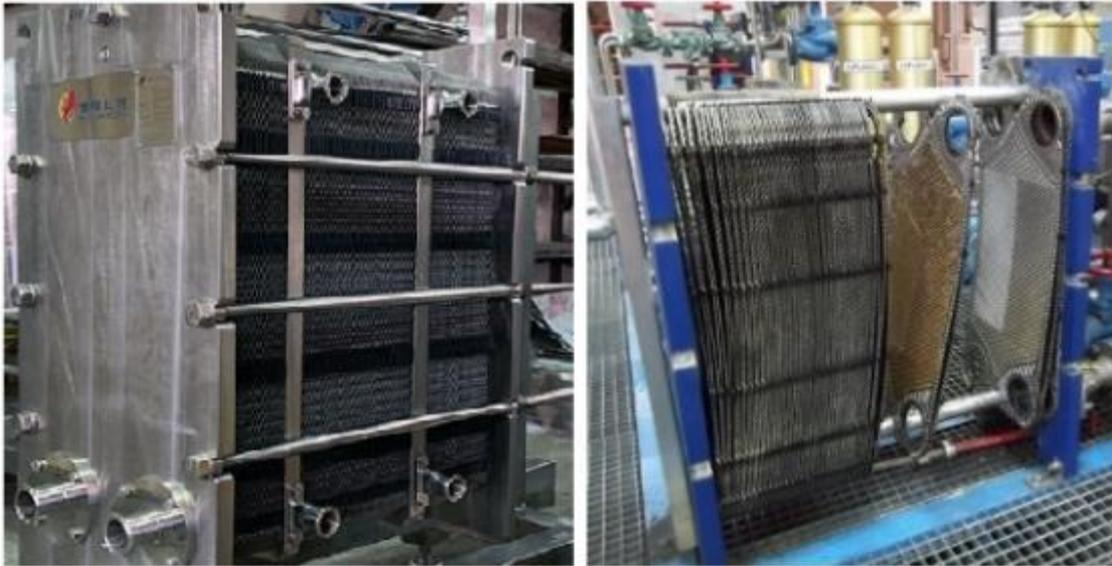
*Figura 165. Intercambiadores de calor de placas*
