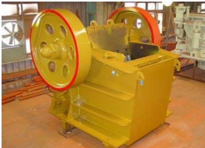
*Figura 171. Trituradora de mandíbulas*
