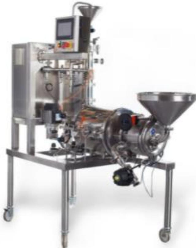
*Figura 65. Molino coloidal para dispersiones líquido-líquido (Bachiller, 2020).*
