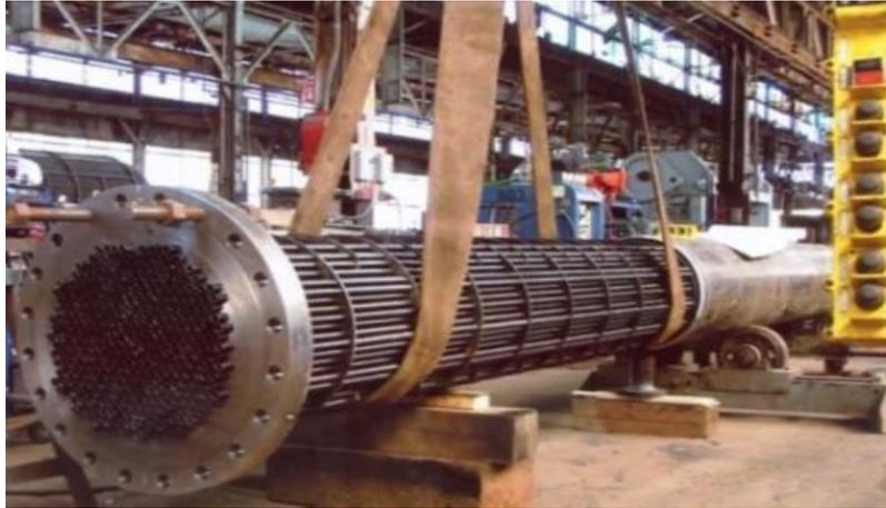
*Figura 162. Intercambiador de calor de tubos y coraza*
