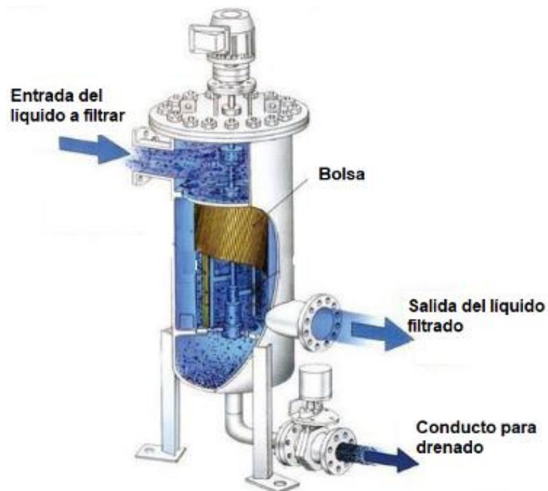
*Figura 30. Funcionamiento de un clarificador de bolsa*
