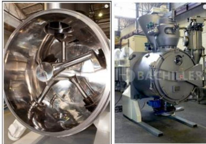
*Figura 101. Secador al vacío horizontal de paletas (Bachiller, 2020).*
