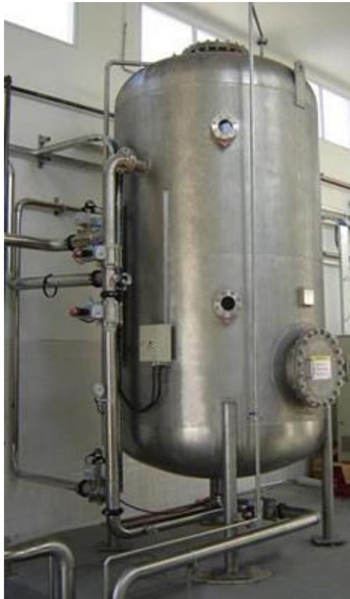
Figura 71. Equipo de adsorción de lecho fijo
