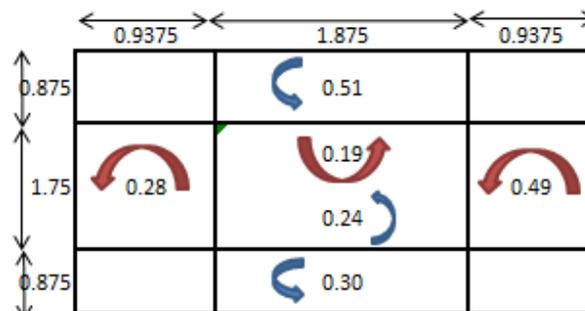
**Figura 64.** Momentos actuantes en tablero de losa.
