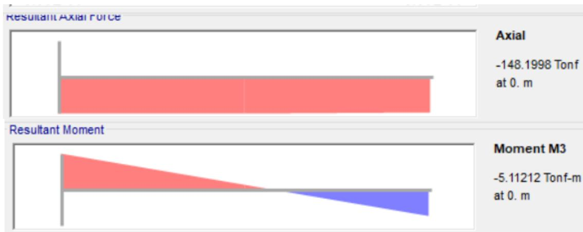
Figura 49. Elementos mecánicos de columna 87. (Primer nivel).
