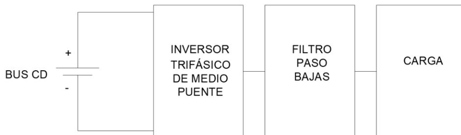
*Figura 13 Topología del Inversor Trifásico de Medio Puente*
