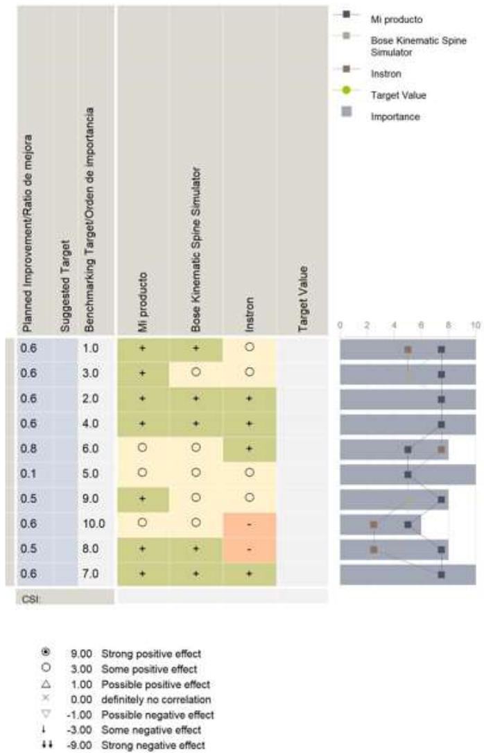
**Figura 3.4** Matriz QFD: Comparación entre la máquina propuesta vs. una comercial y de investigación
