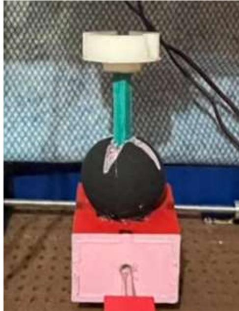
**Figura 5.15** Ensayo de flexión -extensión y flexión lateral
