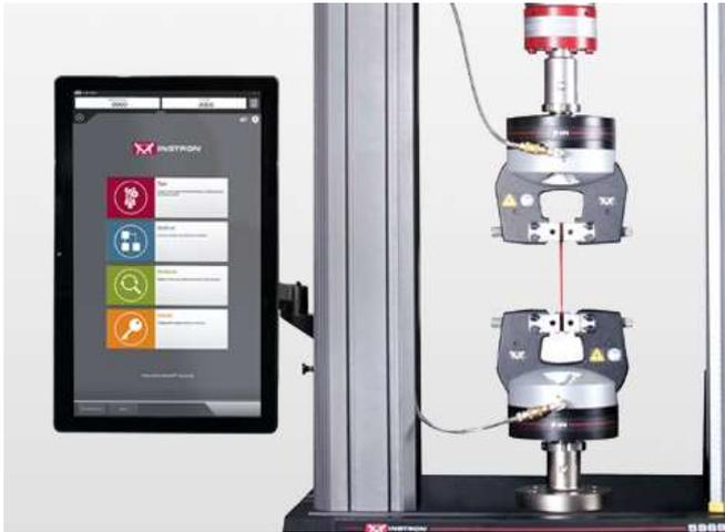
Figura 2.20 Panel del operador <sup>10</sup>
