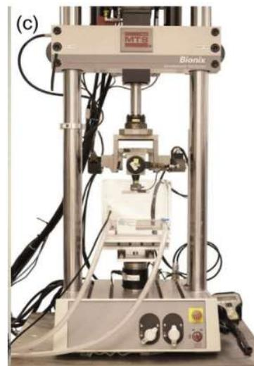
Figura 2.13 Sistema servo hidráulico (GT2) capaz de controlar la posición en cuatro ejes y una plataforma para minimizar las cargas de cizallamiento anteroposterior y medio lateral <sup>20</sup>
