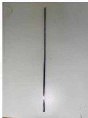
Figura 4.7: Eje longitudinal 5mm  $\Phi$ .
