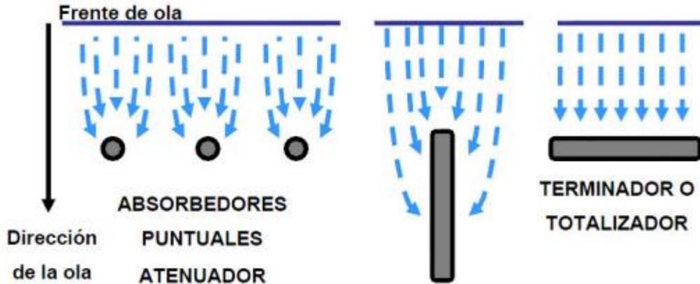
Figura 2.14: WEC's según su posición respecto al oleaje incidente (Tomado de Imaz, 2016)..
