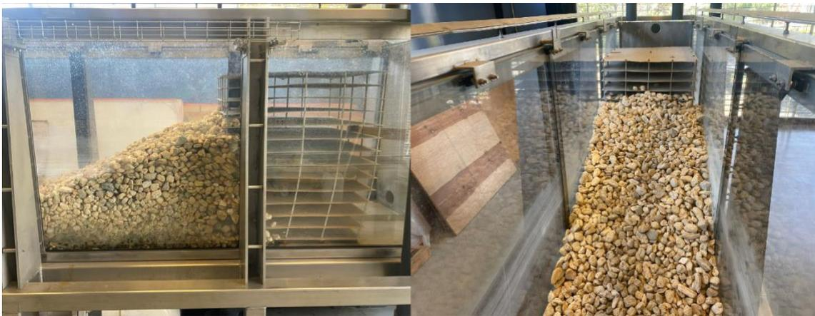
*Figura 3.5: Playa artificial de grava y estructura de soporte.*
